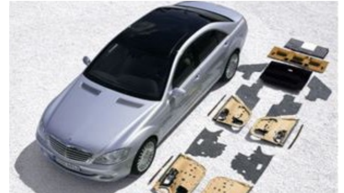
Img. 11 Modelos como el Mercedes-Benz Clase S, tiene 45 piezas de plástico reciclable y 27 partes de materias primas y es el primer coche con certificado ambiental.
