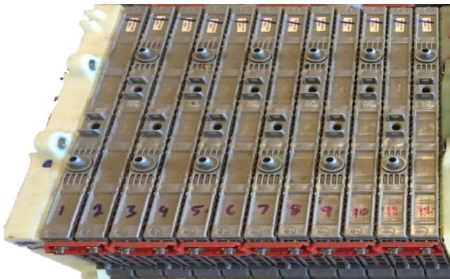
Fig. 4 Conjunto de baterías Níquel - Hidruro Metálico
