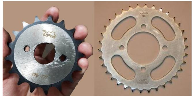
Fig. 9 Piñón 34 dientes y piñón 17 dientes mecanizado.
