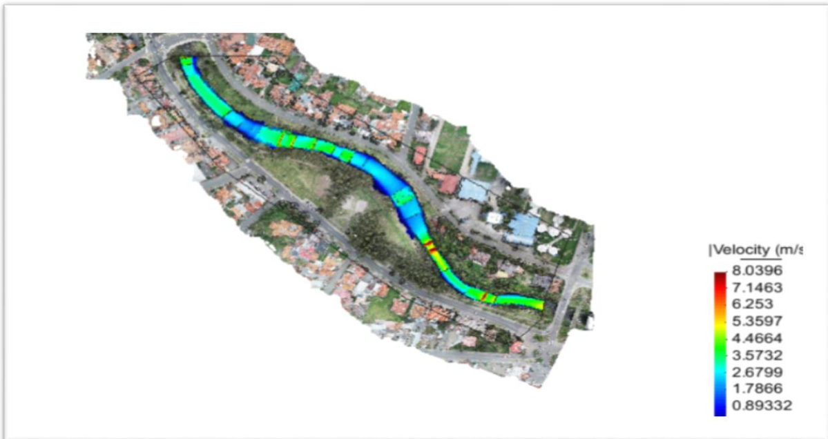
FIGURA 3. 40 Vista en planta con relleno de las máximas velocidades generadas por el hidrograma 4 (Caudal punta = 176.2 m 3 /s)
