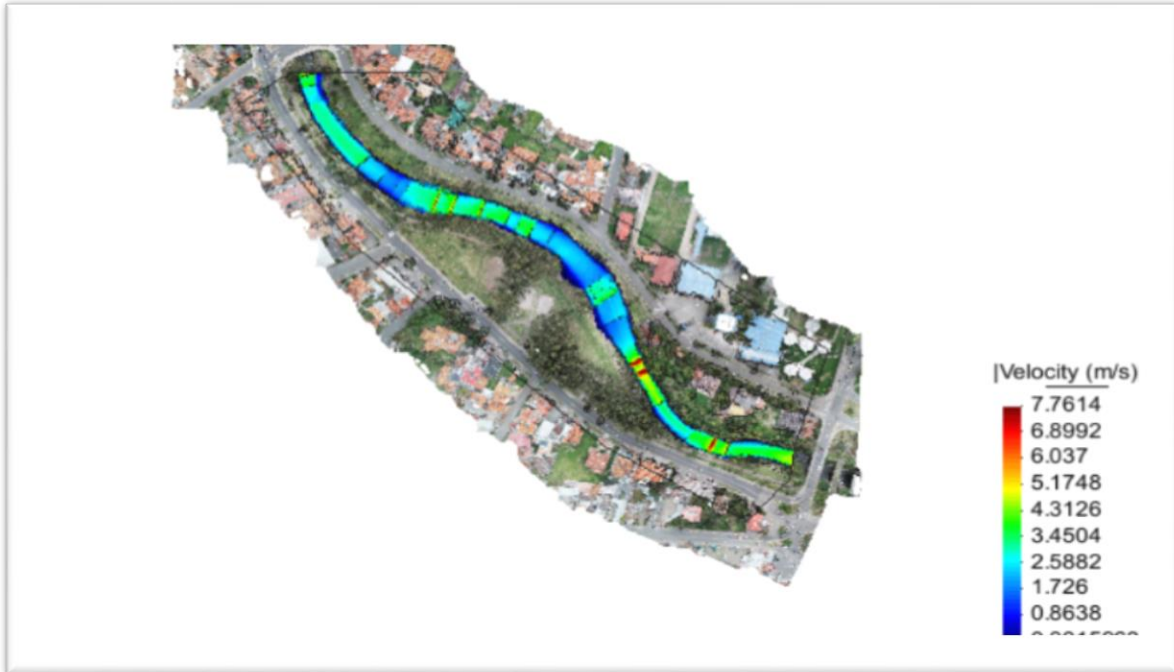
FIGURA 3. 39 Vista en planta con relleno de las máximas velocidades generadas por el hidrograma 3 (Caudal punta = 153.9 m 3 /s)
