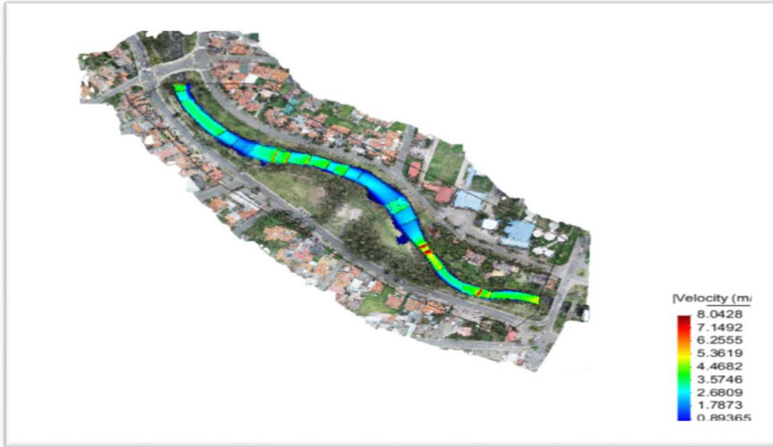
FIGURA 3. 31 Vista en planta sin relleno de las máximas velocidades generadas por el hidrograma 4 (Caudal punta = 176.2 m 3 /s)
