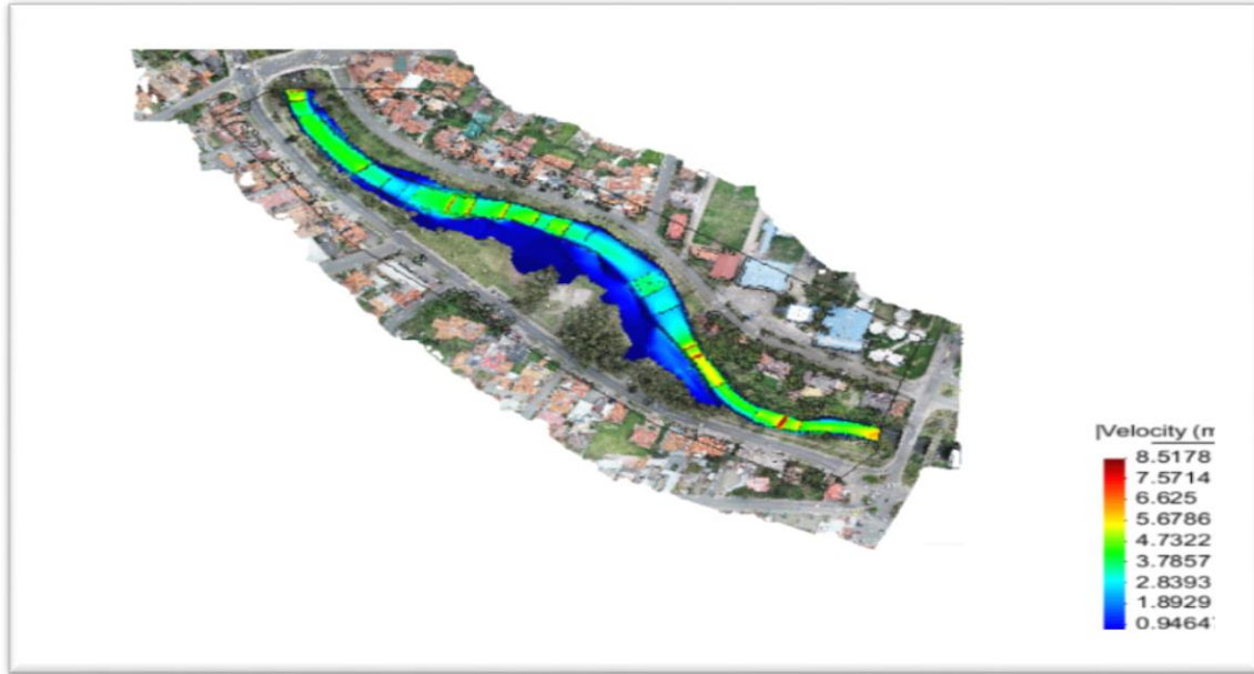
FIGURA 3. 35 Vista en planta sin relleno de las máximas velocidades generadas por el hidrograma 8 (Caudal punta = 273 m 3 /s)
