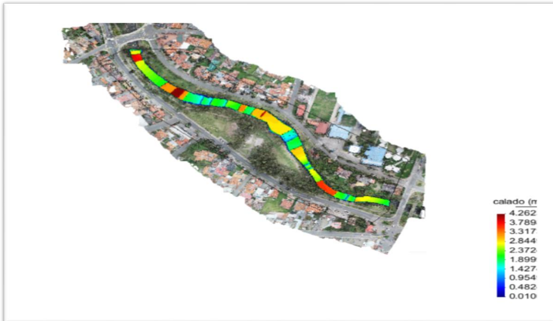
FIGURA 3. 12 Vista en planta de la mancha sin relleno de inundación generada por el hidrograma 3 (Caudal punta = 153.9 m 3 /s).
