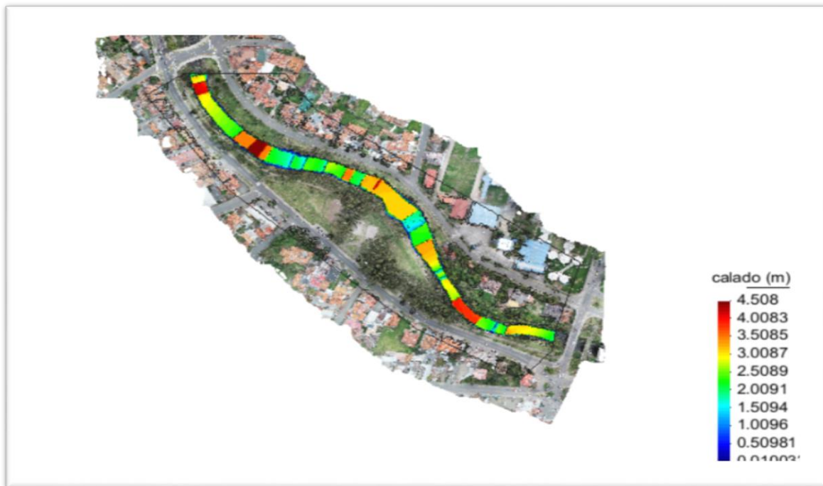
FIGURA 3. 20 Vista en planta de la mancha con relleno de inundación generada por el hidrograma 2 (Caudal punta = 126.4 m 3 /s).
