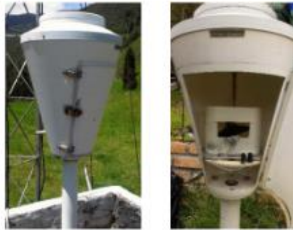
Figura 1.9 Pluviómetro usado de la red de ETAPA.
