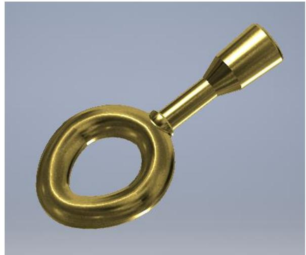
Fig. 4 Modelo base de la argolla de la mordaza de 1 dirección.
