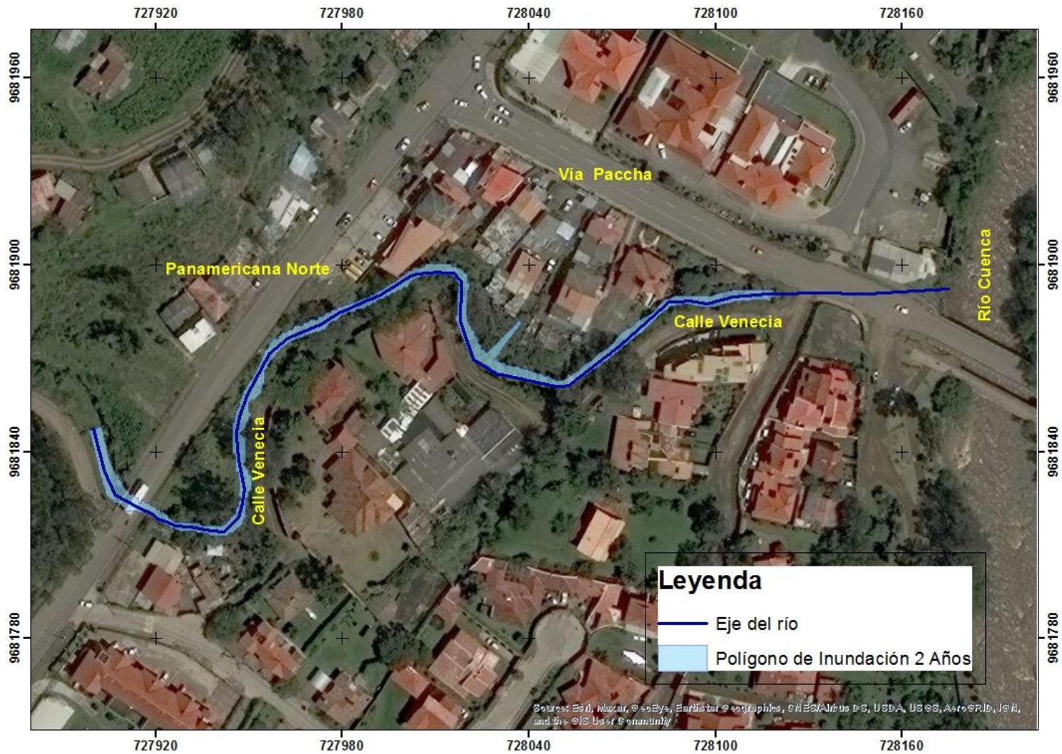
Figura 3.14. Mancha de inundación en el tramo de estudio, con caudal de Tr=2 Años ( Q = 5.41 \text{ m}^3/\text{s} )
