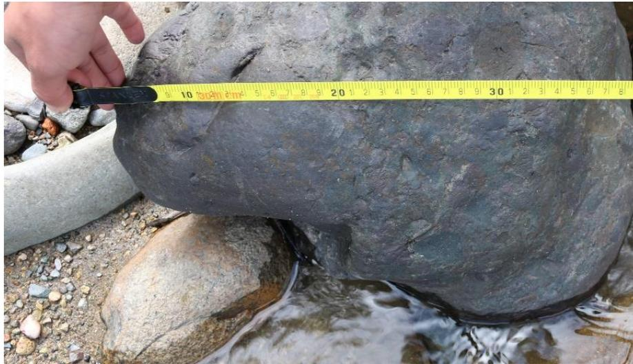
*Figura 2.49 Ejemplo Piedra medida en campo para Factor de Corrección por franja*
