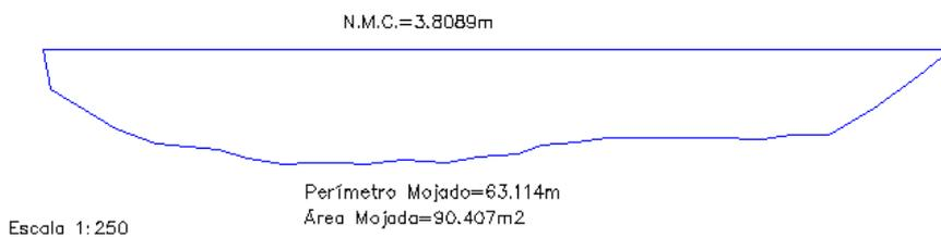
Figura 4.10 Perfiles y secciones transversales Puente Escalinata-Parque de la madre
