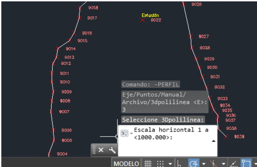
Figura 2.14 Selección de la escala para el perfil transversal
