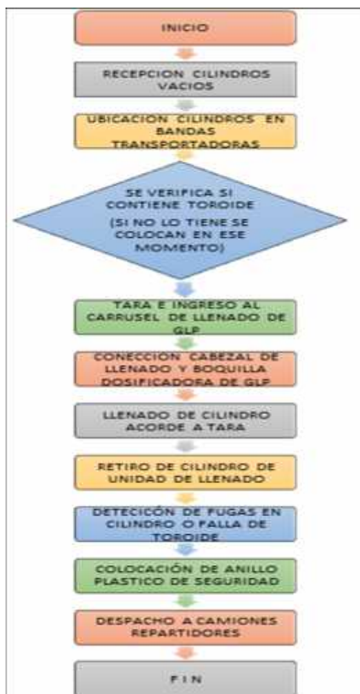
Figura 1. Flujograma de envasado de cilindros de GLP de la empresa AustroGas.
