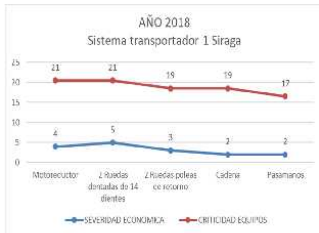
Figura 3. Criterios de Evaluación Sistema transportador #1 Siraga: (Referencia Tabla 7 - Numeral 1)
