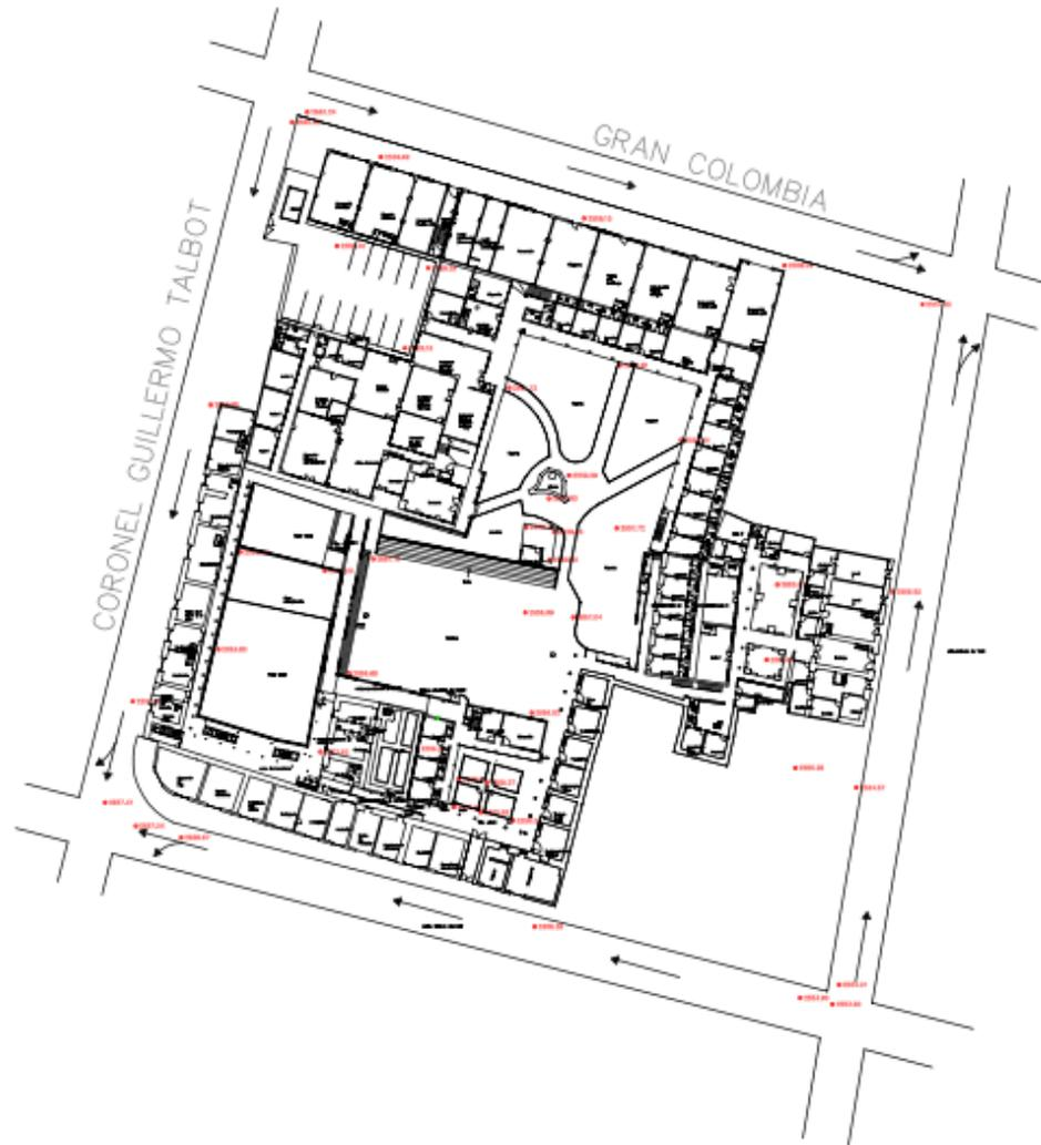
Figura 1.5 Levantamiento topográfico - planimetría predio
