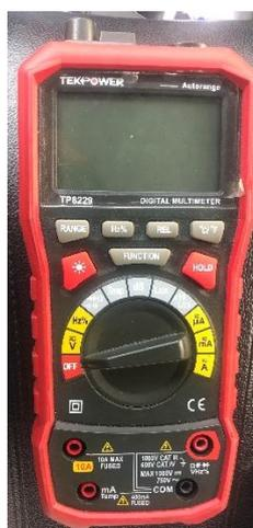
**Figura 40:** Multímetro Digital Multifuncional TP8229.
