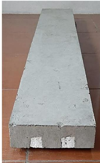
Figura 4.2 Elemento definitivo losa unidireccional tres nervios
