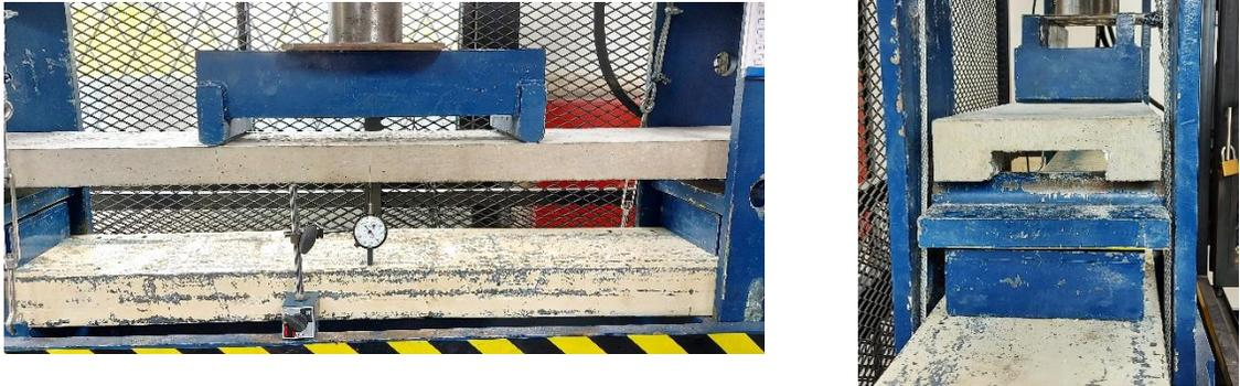
Figura 4.15 Ensayo a flexión losa unidireccional dos nervios
