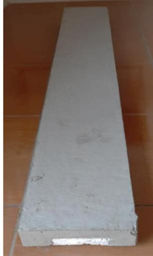
Figura 4.1 Elemento definitivo losa unidireccional dos nervios
