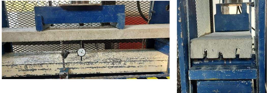
Figura 4.23 Ensayo a flexión losa unidireccional cuatro nervios
