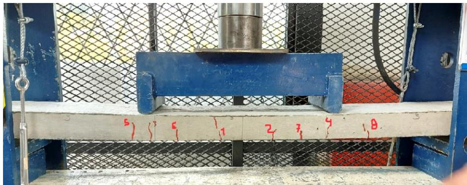
Figura 4.20 Fisuras de losa unidireccional de tres nervios
