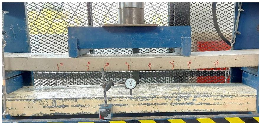
Figura 4.16 Fisuras de losa unidireccional de dos nervios
