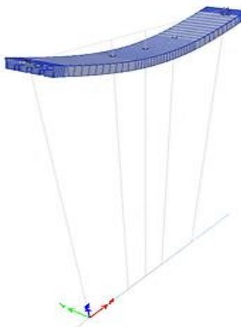
Figura 3.31 Deformación de losa unidireccional cuatro nervios, desplazamiento en el eje z
