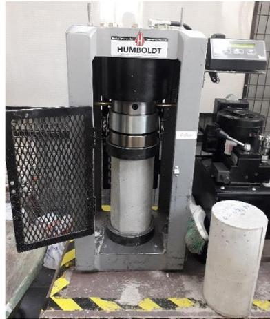
Figura 4.14 Ensayo a compresión
