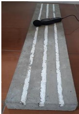
Figura 4.8 Prueba acústica en losas con sonómetro
