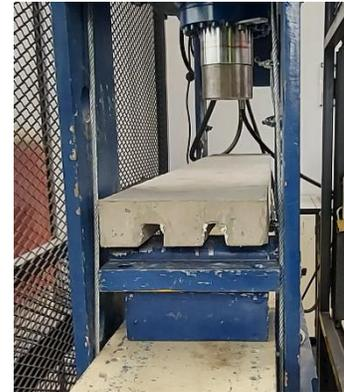
Figura 4.19 Ensayo a flexión losa unidireccional tres nervios
