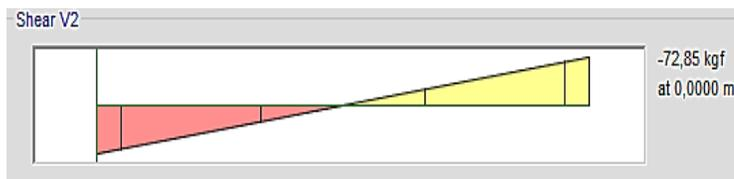
Figura 3.25 Cortante en losa unidireccional dos nervios
