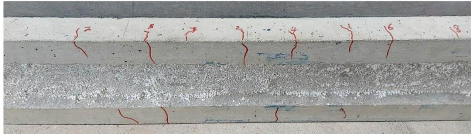
Figura 4.17 Fisuras de losa unidireccional de dos nervios parte inferior
