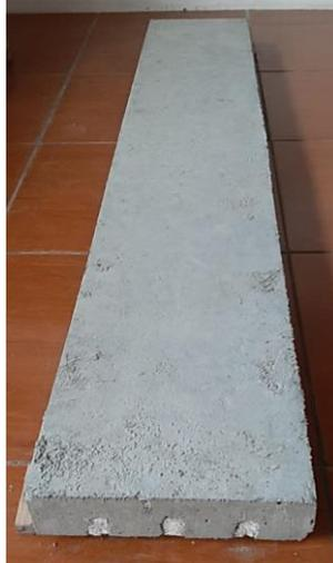
Figura 4.3 Elemento definitivo losa unidireccional cuatro nervios
