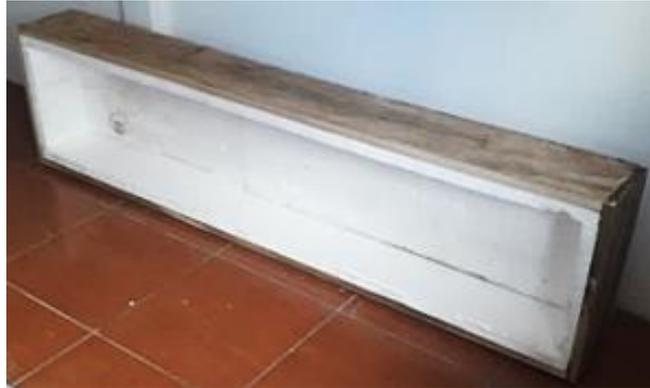
Figura 4.7 Caja para insonorización de losas
