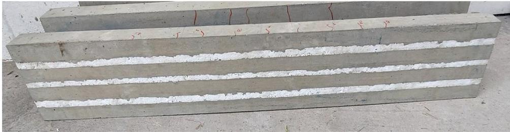
Figura 4.25 Fisuras de losa unidireccional de cuatro nervios parte inferior
