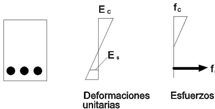
Figura 3.6 Concreto agrietado etapa de esfuerzos elásticos
