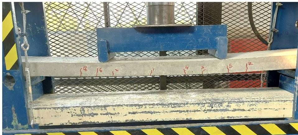
Figura 4.24 Fisuras de losa unidireccional de cuatro nervios
