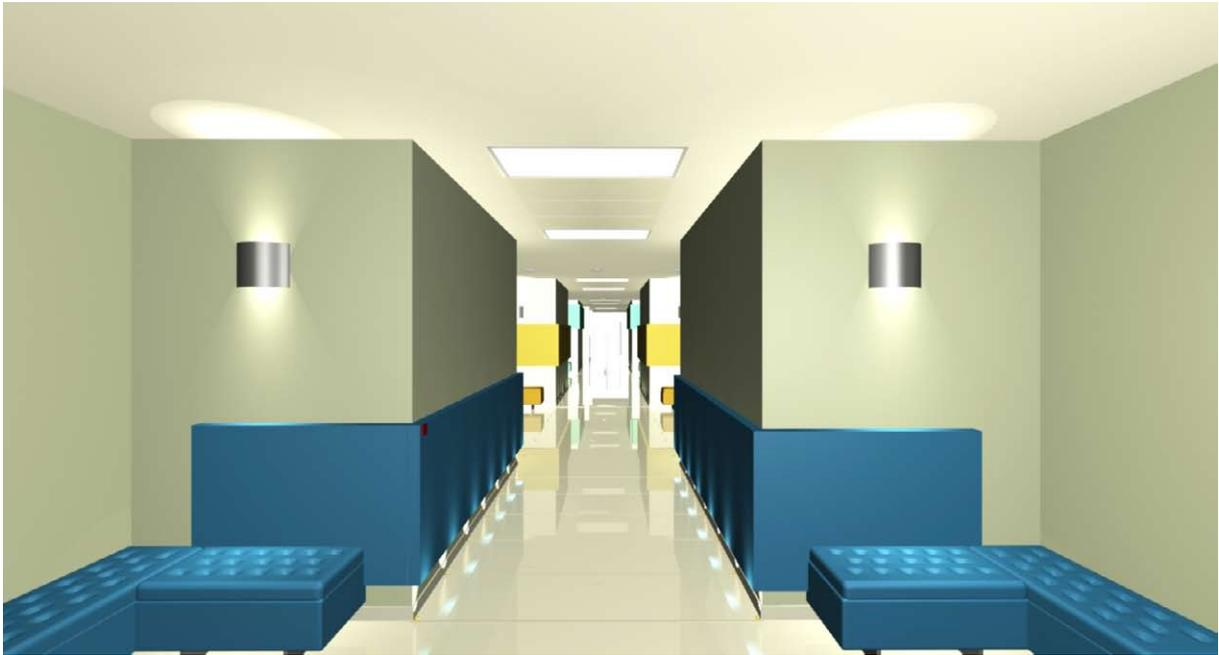
*En los pisos de las áreas de circulación son a base de microcemento alisado y se provocan juntas en los bloques para que tengan correspondencia con las sutiles juntas dejadas en el cielorraso que por cuestión de mantenimiento son de espuma flex para poder desmontar.*
