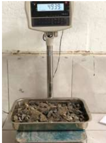
Figura 3.7 Determinación de masa retenida en los tamices Fuente: La autora
