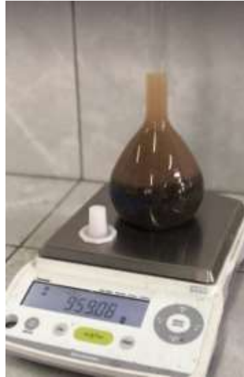
Figura 3.19 Matraz lleno de agregado fino y agua hasta la marca de calibración. Fuente: La autora
