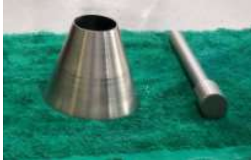
Figura 3.10 Molde compactador para el ensayo de humedad superficial en el agregado fino. Fuente: La autora
