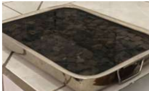
Figura 3.11 Muestra de agregado grueso sumergida en agua. Fuente: La autora
