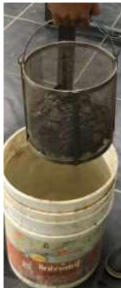
Figura 3.13 Sumersión del agregado grueso saturado superficialmente seco (SSS) de la canasta en el taque de agua. Fuente: La autora
