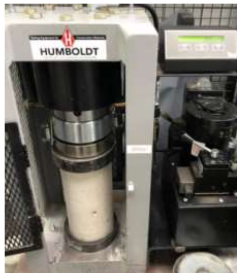
Figura 4.14 Ensayo de compresión de un cilindro de hormigón.
