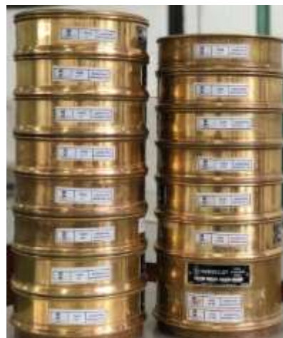
Figura 2.2 Tamices normados por la ASTM necesarios para el ensayo granulométrico.
