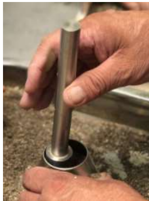
Figura 3.16 Compactación del agregado en el cono truncado. Fuente: La autora
