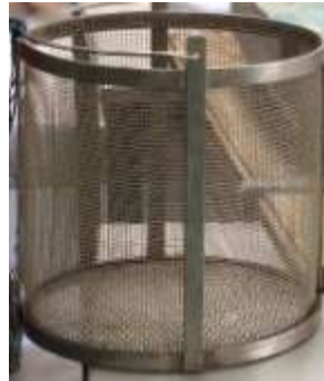
Figura 3.8 Canasta de alambre para el ensayo de gravedad específica para el agregado grueso. Fuente: La autora
