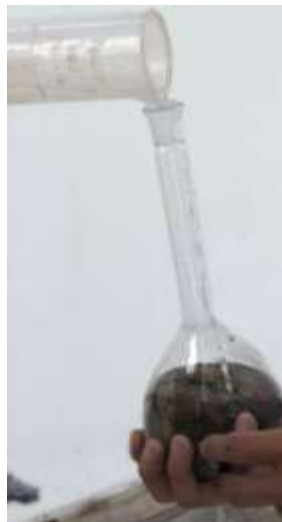
Figura 3.18 Adición de agua en el matraz previo a la agitación para eliminar burbujas de aire. Fuente: La autora
