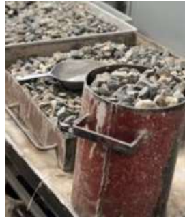
Figura 3.21 Molde relleno con la última capa de material previo a la compactación. Fuente: La autora
