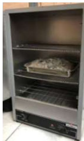
Figura 3.3 Secado de la muestra de agregado en el horno a temperatura controlada por 24 horas. Fuente: La autora
