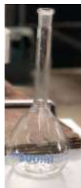
Figura 3.9 Matraz para el ensayo de gravedad específica para el agregado fino. Fuente: La autora
