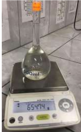
Figura 3.17 Determinación de la masa del matraz con agua hasta la marca de calibración. Fuente: La autora
