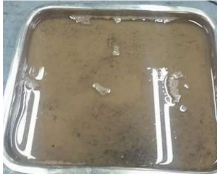
Figura 3.15 Muestra de agregado fino sumergida en agua para lograr la saturación. Fuente: La autora
