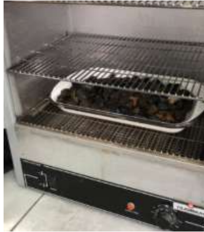
Figura 3.14 Secado de la muestra de agregado grueso en el horno a temperatura controlada. Fuente: La autora
