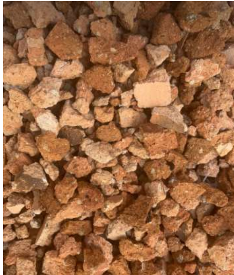
Figura 3.1 Ladrillo triturado proveniente de demolición Fuente: La autora
