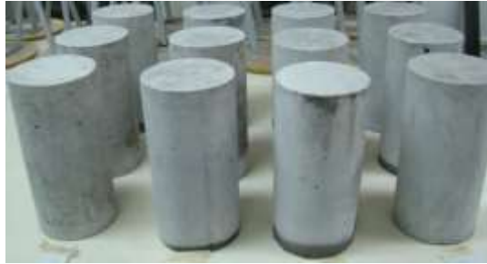
Figura 4.13 Cilindros de hormigón después de ser desmoldados. Fuente: La autora
