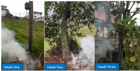
Fig. 62. Simulación de llama individual para cada Nodo.
