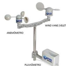
Fig. 10. Estación meteorológica WS3000 [30].
