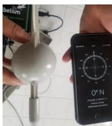
Fig. 31. Calibración mediante Smart Phone.
