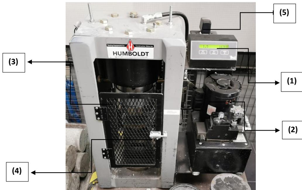
Figura 2.18. Ilustración de los componentes de la Máquina de Compresión “Humboldt”.
