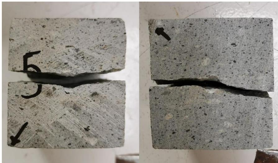
Figura 2.17 Resultado de ruptura de la probeta.
