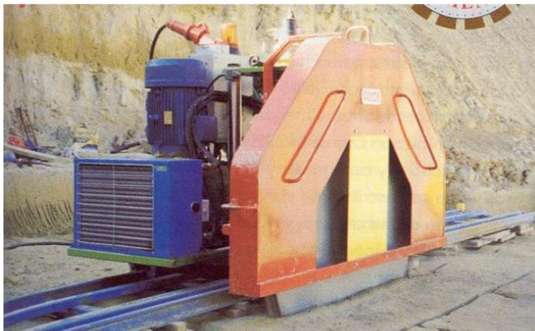
Figura 1.13. Máquina de Corte con Disco.
