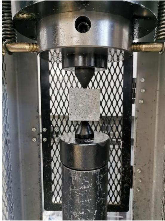
Figura 2.16. Ubicación correcta de la probeta entre las puntas cónicas.
