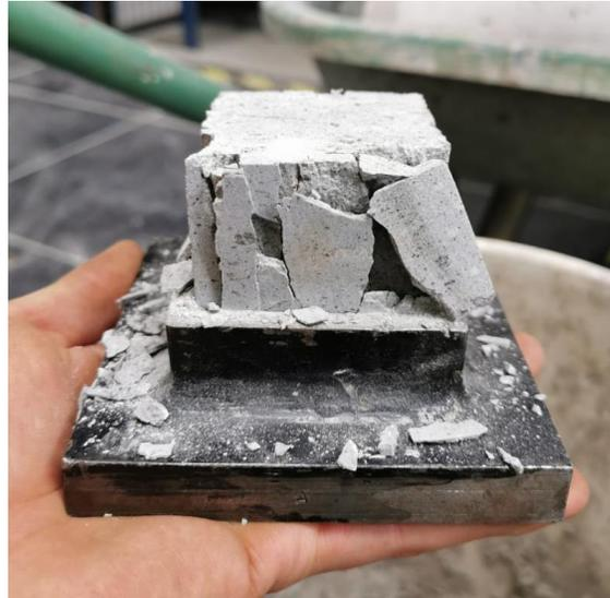
Figura 2.22. Resultado de ruptura de la probeta.
