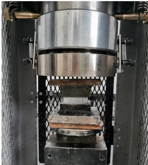
Figura 2.21. Inicio de ruptura de la probeta.
