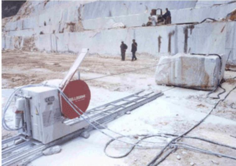
Figura 1.11. Equipo Eléctrico Automático con Hilo Diamantado.
