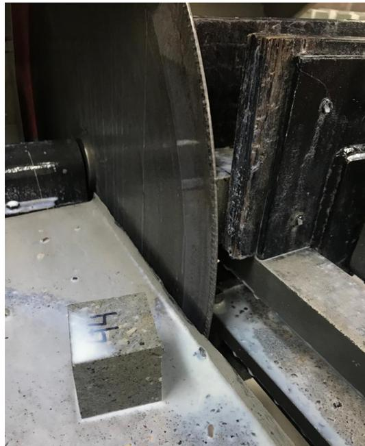
Figura 2.11. Resultado del corte de la probeta.
