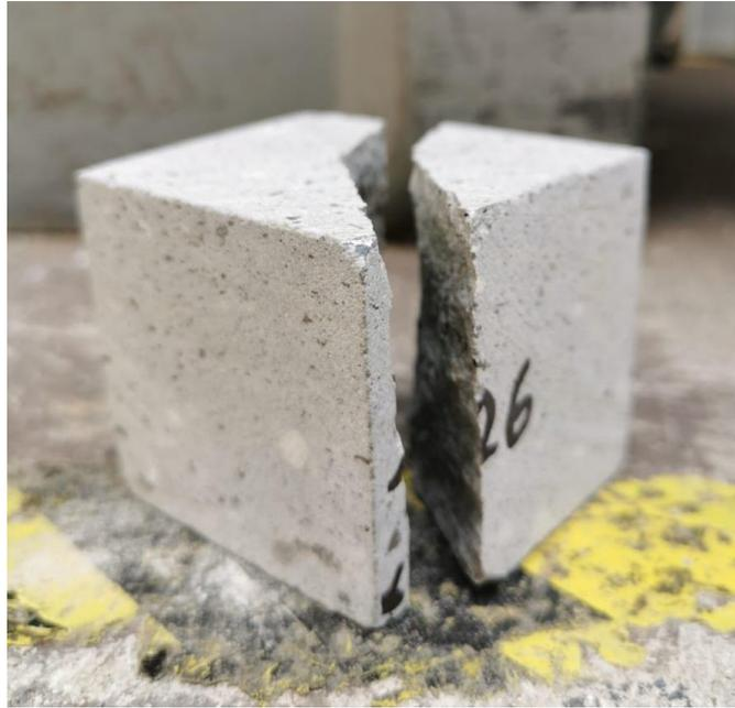
Anexo 6. Vista superior de ruptura de la probeta en compresión simple.
