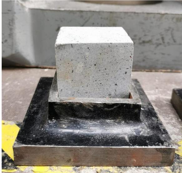
Figura 2.20. Posicionamiento de la probeta.
