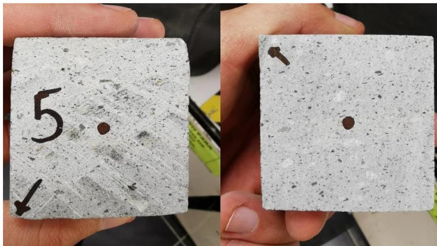
Figura 2.15 Marcación del punto intermedio en la parte superior e inferior de la probeta antes de la ruptura.
