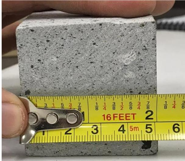
Figura 2.5. Ancho de la Probeta.
