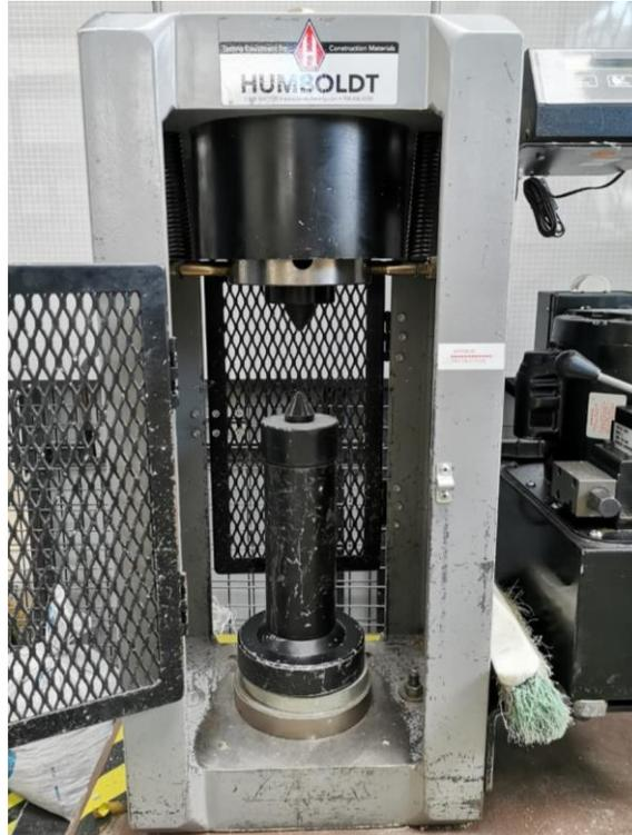
Figura 2.13 Puntas cónicas acopladas a la prensa Humboldt.
