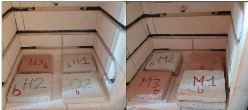
Figura 0.11 Muestras pre quema, 1000 °C y 3 hr 20 min
