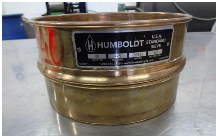
Figura 0.6 Equipo de tamizado Humboldt empleado para la arcilla
