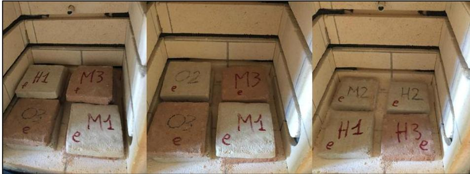
Figura 0.14 Muestras pre quema, 1300 °C y 4 hr 20 min
