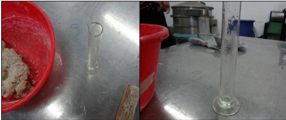
Figura 0.2 Preparado de la mezcla y herramienta de medición del volumen de agua añadido
