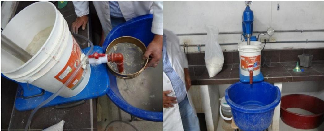
Figura 0.8 Proceso de lavado y celda de flotación Denver
