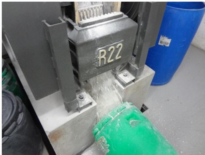
Figura 0.4 Molino de mandíbulas
