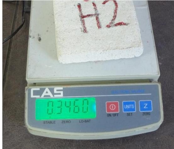
Figura 0.4 Determinación de las masas del material moldeado y secado a la intemperie empleando balanza digital
