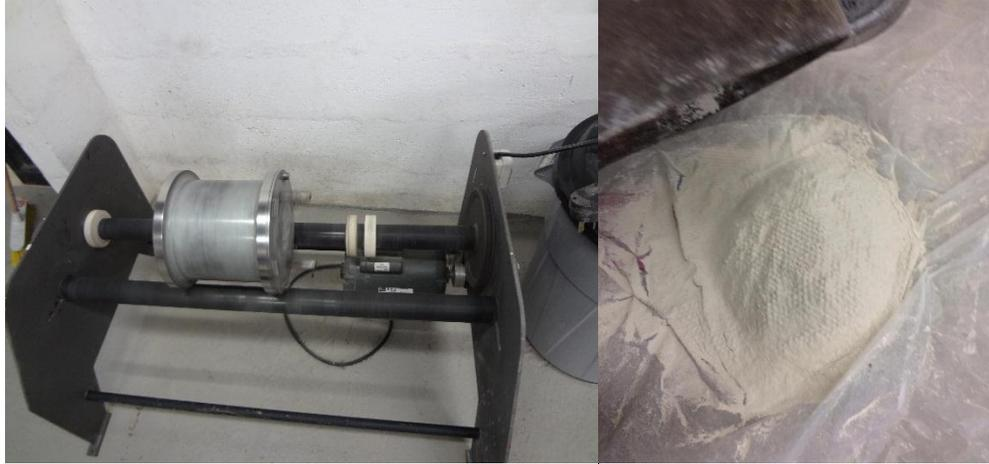
Figura 0.3 Molino de bolas y muestra de material de arcilla con tamaño de granos reducido
