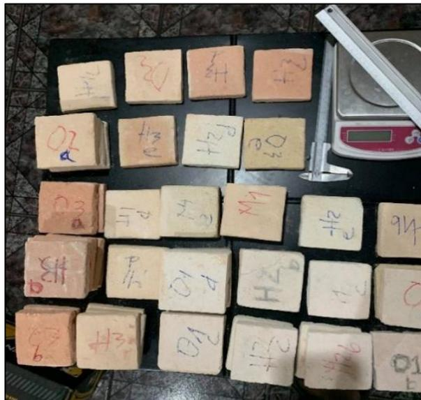
Figura 0.15 Muestras pos quema y balanza digital
