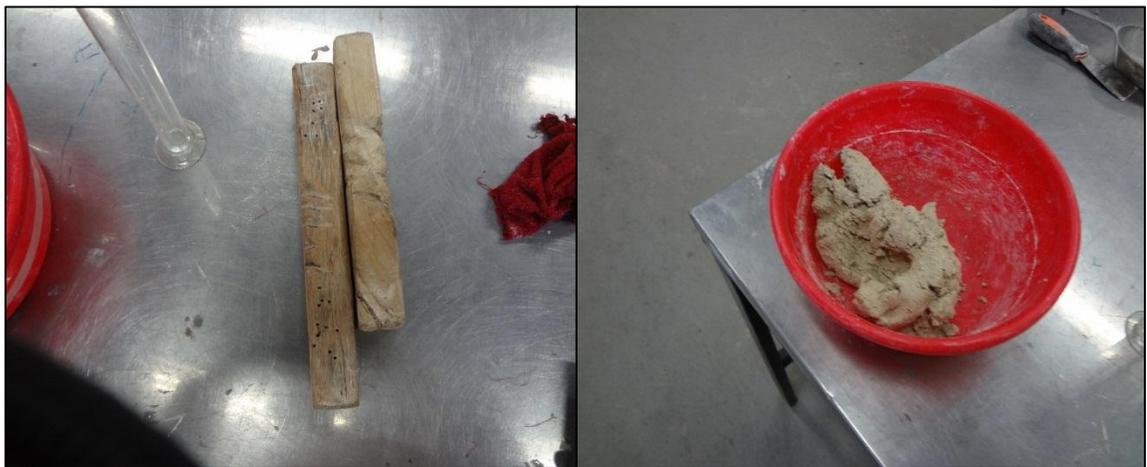
Figura 0.1 mezcla de material y tacos de madera empleados para compactar la mezcla
