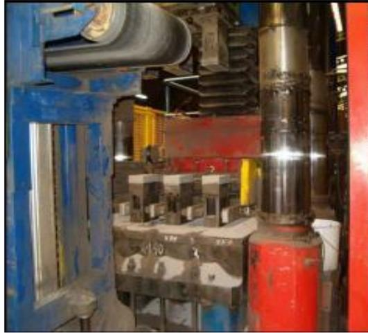
Figura 0.13 Prensa hidráulica para la elaboración de ladrillos refractarios
