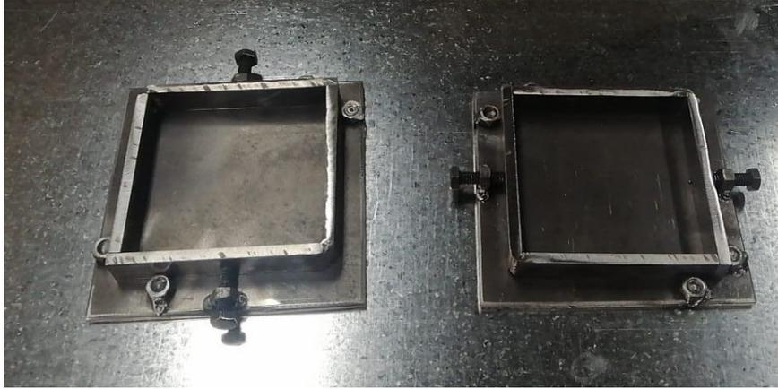
Figura 0.11 Molde de matricería en la fabricación de muestras
