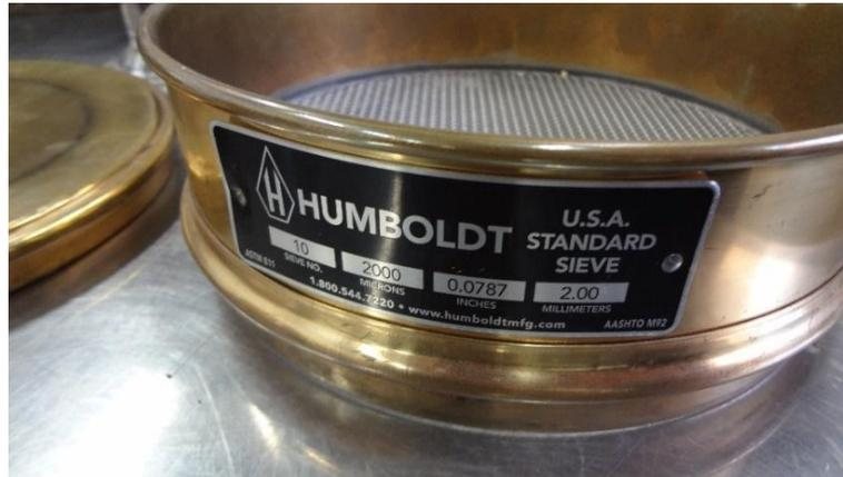
Figura 0.7 Equipo de tamizado Humboldt empleado para la chamota
