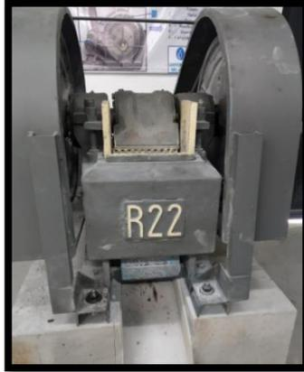
Figura 28: Trituradora de mandíbulas
