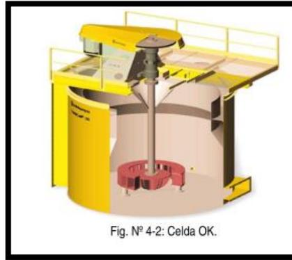
Figura 20: Máquina de flotación mecánica
