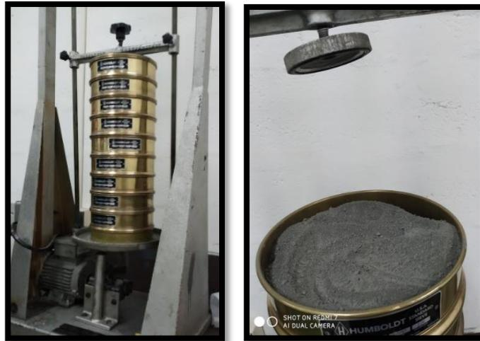
Figura 32: Análisis granulométrico
