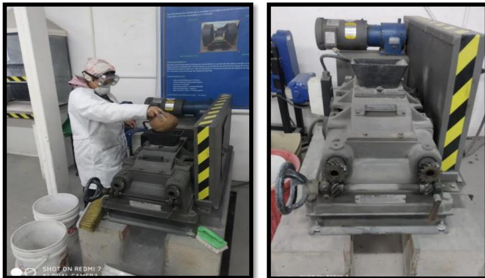
Figura 29: Trituradora de rodillos-trituración secundaria
