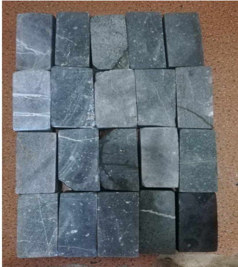
Figura 2.5. Muestras de roca para ensayo de Resistencia a la Compresión Simple (RCS). Fuente Elaboración propia.
