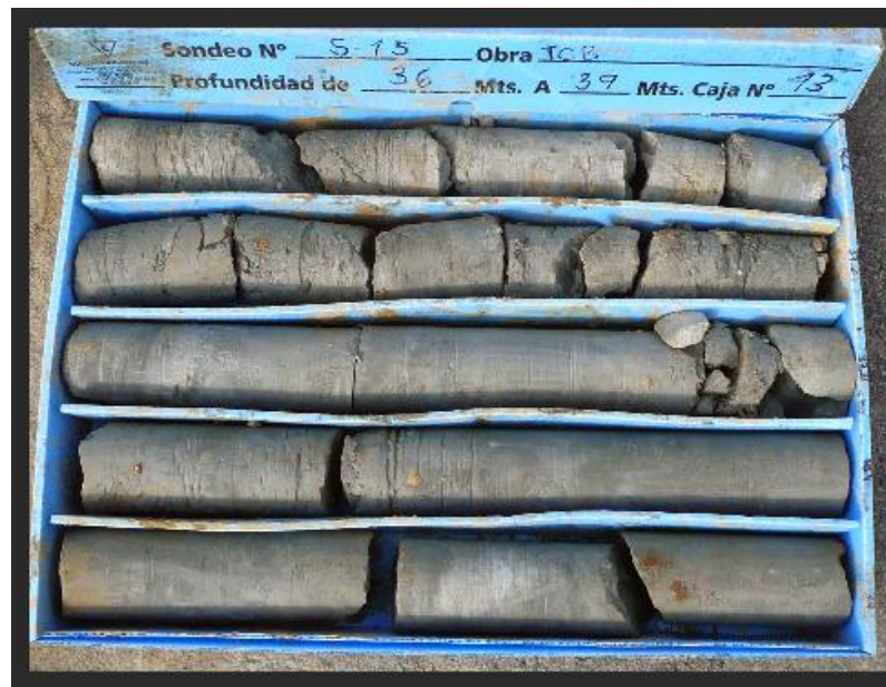
Figura 1.4 Testigos de sondeo para determinación del RQD. Fuente: Córdova D, 2016
