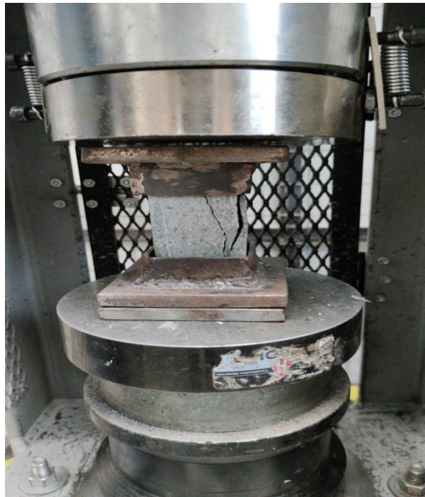
Figura 3.1. Muestra siendo sometida a RCS por la prensa hidráulica.
