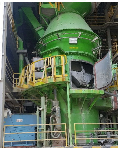
Figura 2. Equipo Molino Vertical PFEIFFER MPS 2500 BC de Cemento Atenas (enero, 2019)
