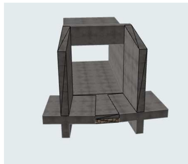
Perspectiva alcantarilla salida
