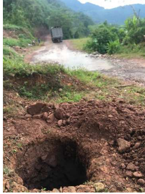
Ilustración 10: Pozo de muestra de suelo
