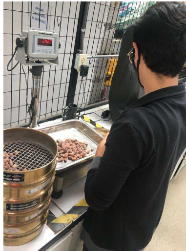
Ilustración 15: Peso de material retenido en cada tamiz
