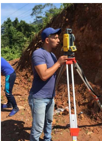
Ilustración 5: Plantación del equipo topográfico en campo
