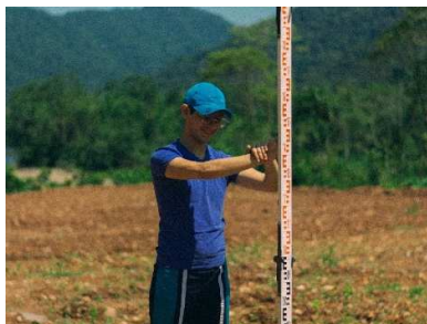
Ilustración 6: Trabajo de cadeneros, toma de puntos
