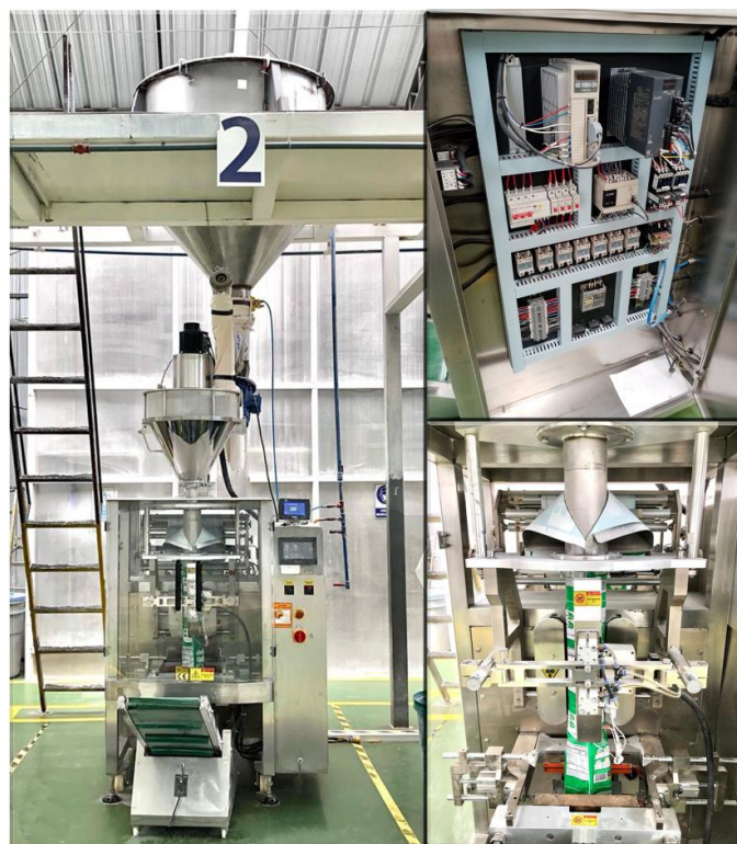
Figura 3: Envasadora vertical automática de línea de envasado
