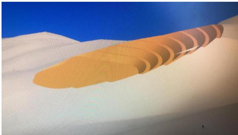
Figura 3.31. Modelo final de la superficie, con el *pit* generado.
