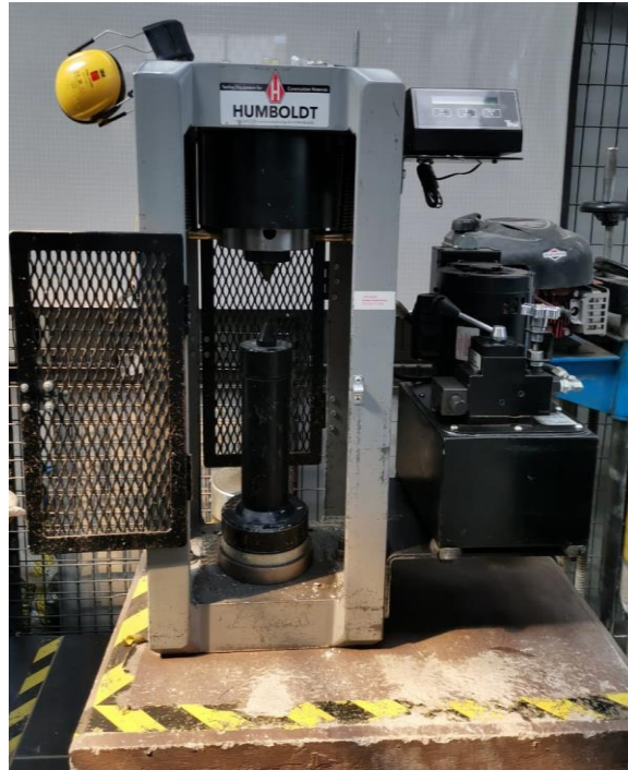
Figura 2.24 Prensa Humboldt modelo CM-2500-DIR Fuente: Elaboración propia.
