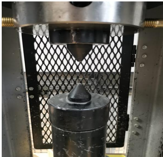
Figura 2.23 Puntas cónicas acopladas a la prensa Humboldt. Fuente: Elaboración propia.
