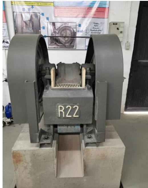
Figura 2.10. Trituradora de Mandíbulas R22. Fuente: Elaboración propia.
