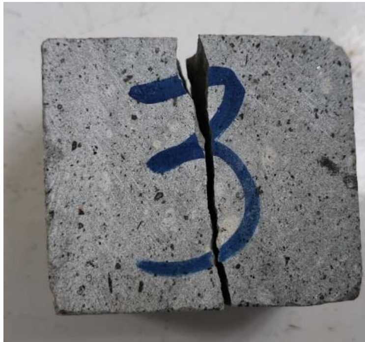
Figura 2.28 Resultado de la ruptura en la prensa Humboldt. Fuente: Elaboración propia.
