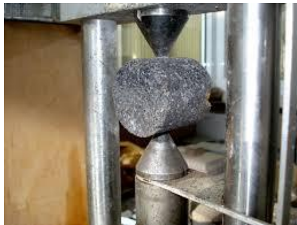
Figura 1.13 Ensayo de carga puntual.
