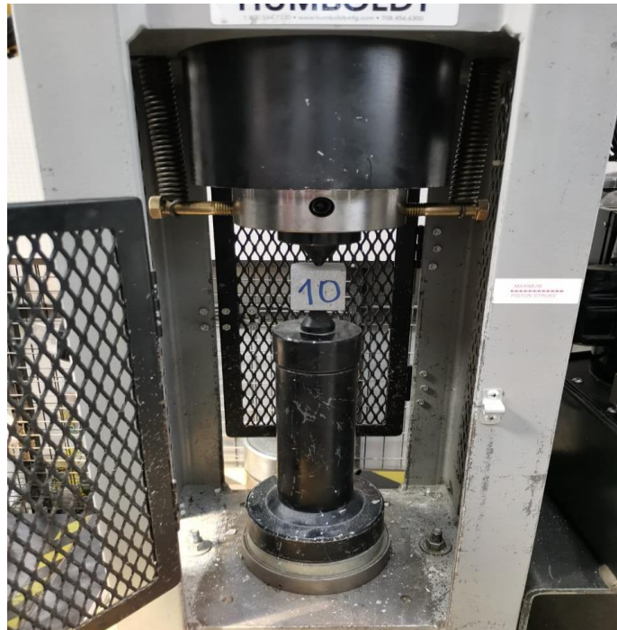
Figura 2.27 Ubicación de la muestra entre las puntas cónicas. Fuente: Elaboración propia.
