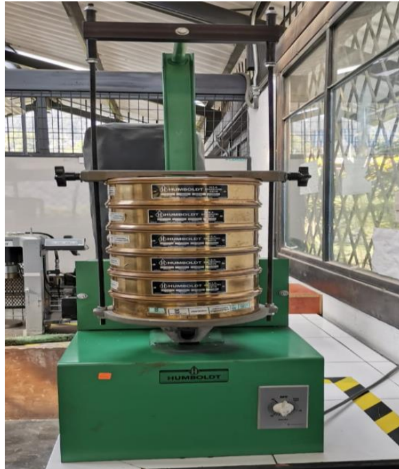
Figura 2.14. Clasificación en la tamizadora eléctrica. Fuente: Elaboración propia.
