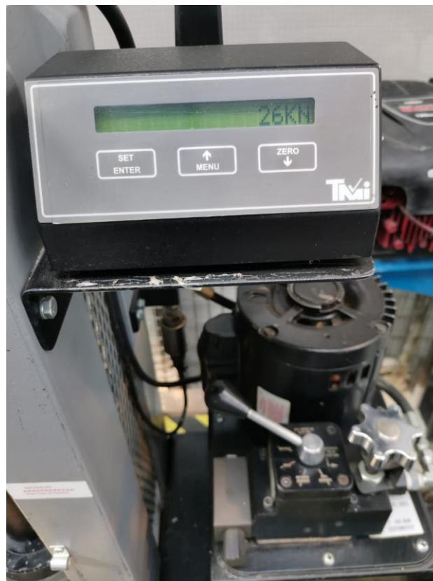
Figura 2.29 Resultado de la fuerza ejercida en kN. Fuente: Elaboración propia.
