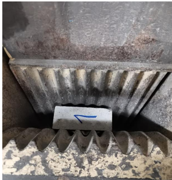
Figura 2.11. Disposición de la Muestra en la Trituradora. Fuente: Elaboración propia.
