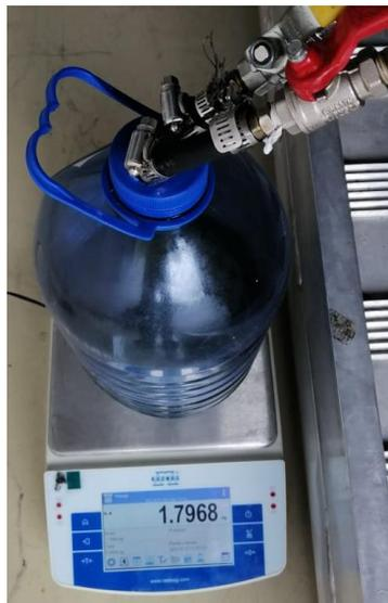
**FIGURA 20:** PESAJE DEL DEPÓSITO DE SUMINISTRO CON COMBUSTIBLE.
