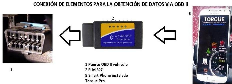
**FIGURA 16:** CONEXIÓN DE ELEMENTOS PARA LA OBTENCIÓN DE DATOS VÍA OBD II
