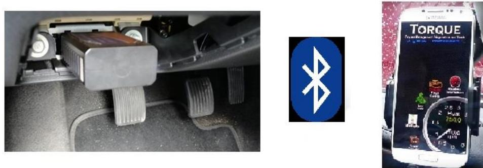
**FIGURA 17:** VINCULACIÓN ELM 327 Y TORQUE-PRO®
