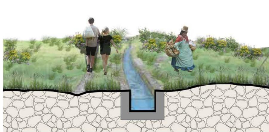
FIG 126 | Sección canales de riego. Fuente: Elaboración propia.
