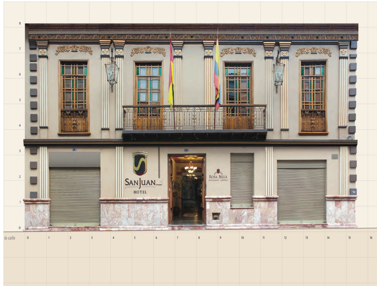
Figura 38: Fotogrametría Hotel San Juan, Cuenca. Fuente: El patrimonio edificado de Cuenca registro gráfico número 2, Universidad del Azuay.
