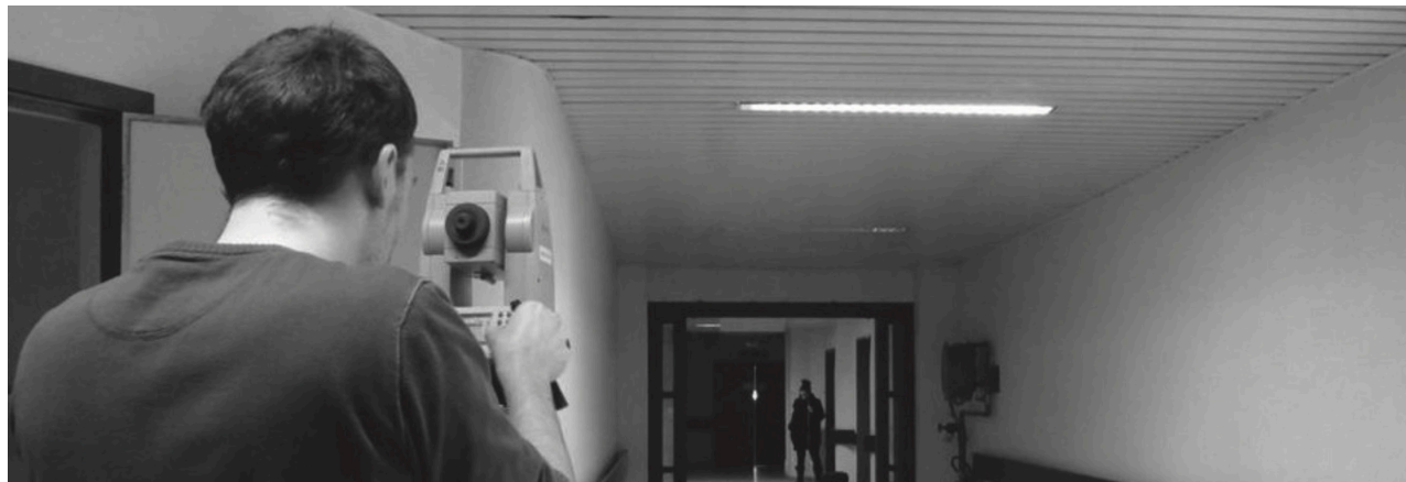
Figura 35: Uso de estación total para el levantamiento de información. Fuente: Proyecto vliirCPM.
