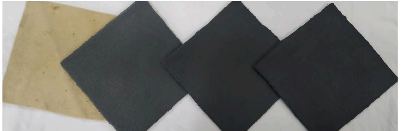
Gráfico 47: Aislante acústico a partir del caucho obtenido de los neumáticos reciclados.
