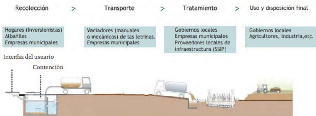
Figura 1. Cadena de saneamiento y manejo de lodos fecales.
