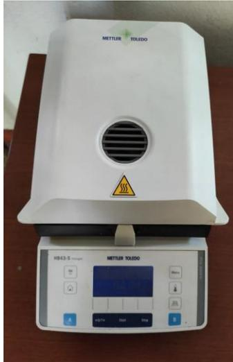
Figura 12. Medidor de humedad HB43-S Halogen
