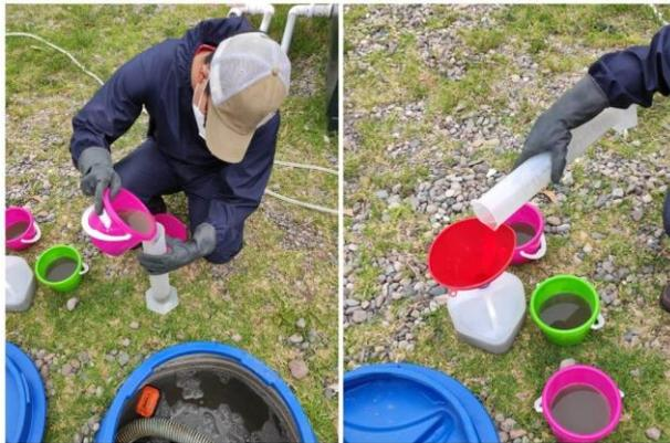
Figura 8. Medición y depósito de la muestra de Salida.
