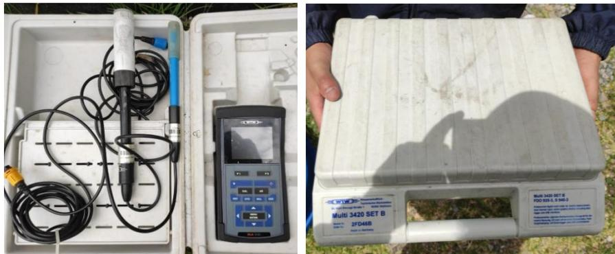
Figura 9. Máquina de medición WTW Multi 3420
