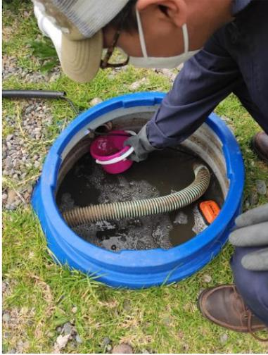
Figura 7. Toma de muestras a la salida del humedal
