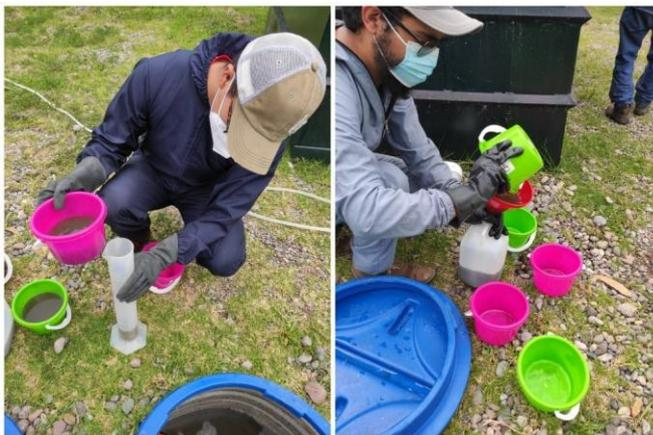
Figura 6. Medición y depósito de la muestra de Entrada.
