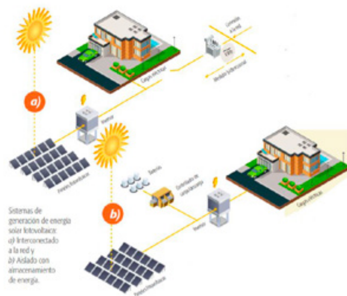
Figura 38. Esquema de funcionamiento de paneles solares
