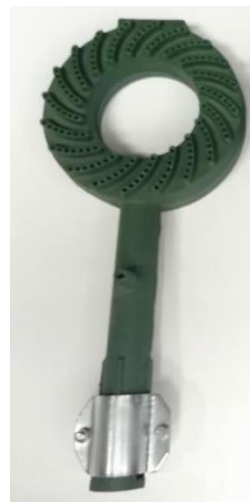
Fig. 7. Quemador que se utiliza en la estructura.
