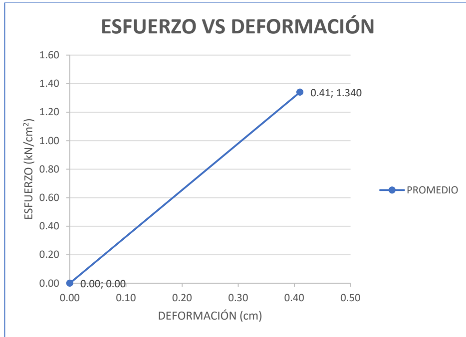
Figura 4.12 Esfuerzo vs deformación promedio viguetas de hormigón con acero como refuerzo
