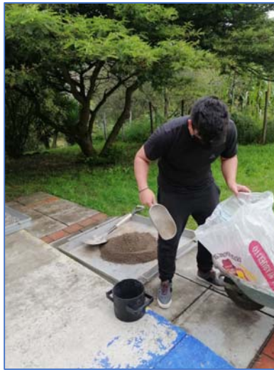
Figura 3.12 Colocación del volumen necesario de árido fino y grueso para la elaboración de las muestras (20 viguetas y 4 probetas)
