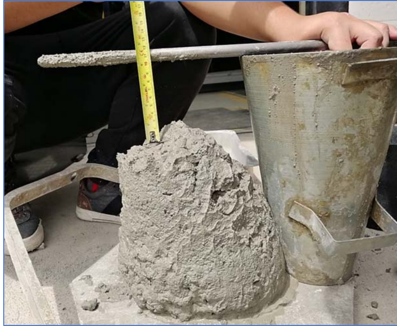
Figura 3.16 Asentamiento cono de Abrams
