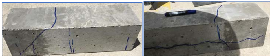
Figura 4.17 Fallas presentadas en muestra de refuerzo bambú (tablillas)
