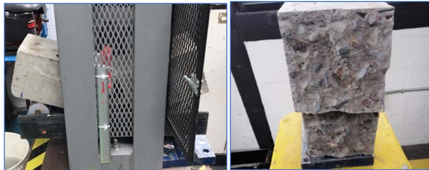
Figura 4.7 Fallas presentadas en muestra de hormigón
