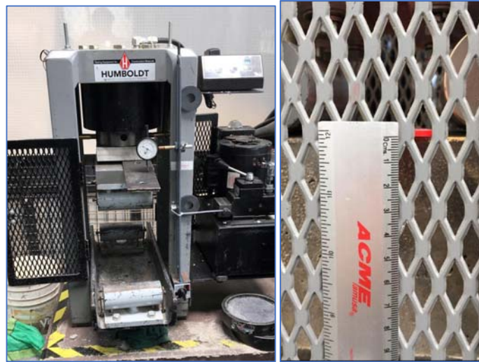
Figura 4.3 Prensa para ensayo a flexión con los mecanismos de medición de deformación adaptados
