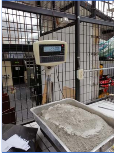
Figura 3.13 Pesado de cemento necesario de cemento para la elaboración de las muestras (20 viguetas y 4 probetas)
