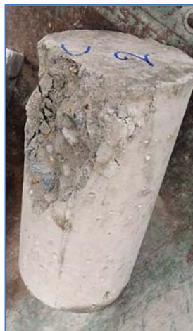
Figura 4.1 Cilindros luego de ser ensayados a la compresión simple
