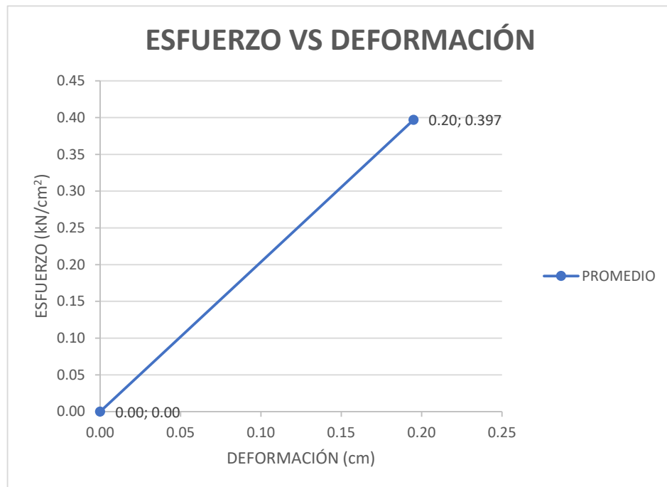
Figura 4.19 Esfuerzo vs deformación promedio viguetas de hormigón con refuerzo de bambú (Tablilla)
