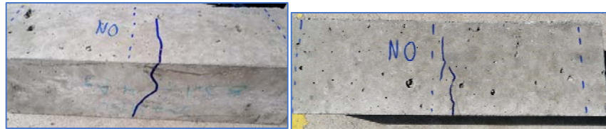
Figura 4.20 Fallas presentadas en muestra de refuerzo bambú (trenza)
