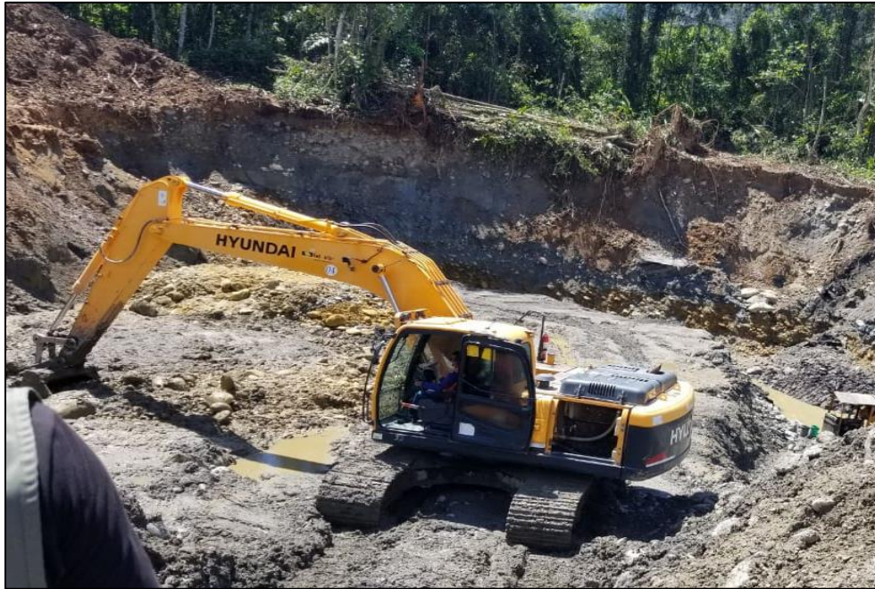
Figura 2. 10 Excavadora realizando stock de grava con mineral (Oro) Concesión: LA MISIONERA sector Nayanmak.
