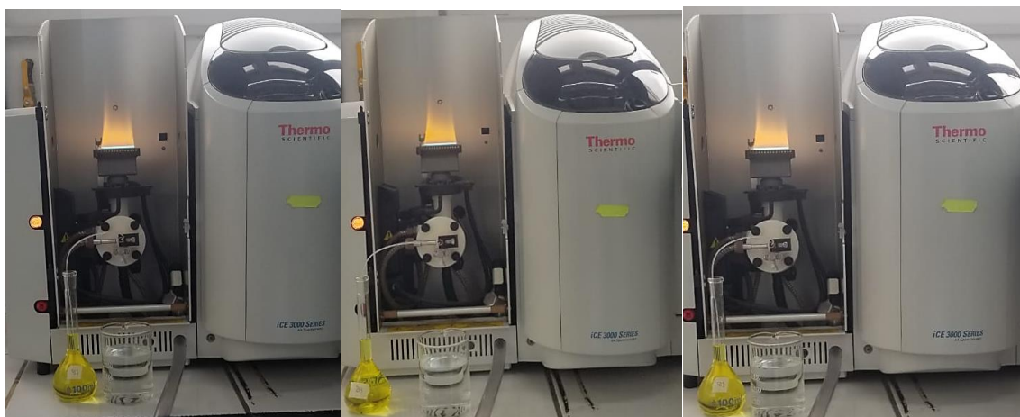
Figura 2. 32 Lectura de las muestras en el Equipo de Absorción Atómica.
