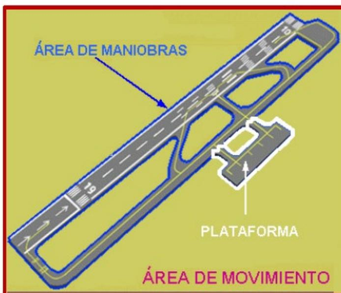
Ilustración 1.5: Área de Movimiento de un Aeropuerto
