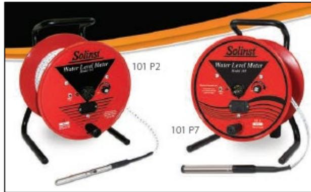
Ilustración 4.15: Medidores de nivel de agua 101 Solinst. Fuente: (Solinst Canada Ltd., 2016)
