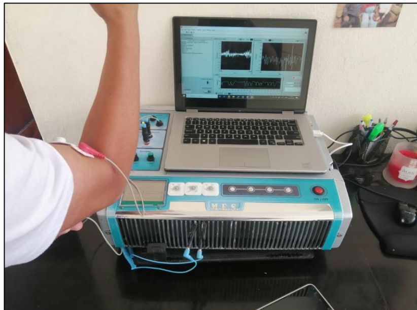
Figura 4.1 Colocación electrodos Bíceps
