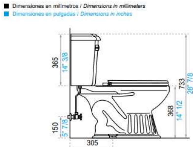
Figura 9.1: Pieza sanitaria: Inodoro.
