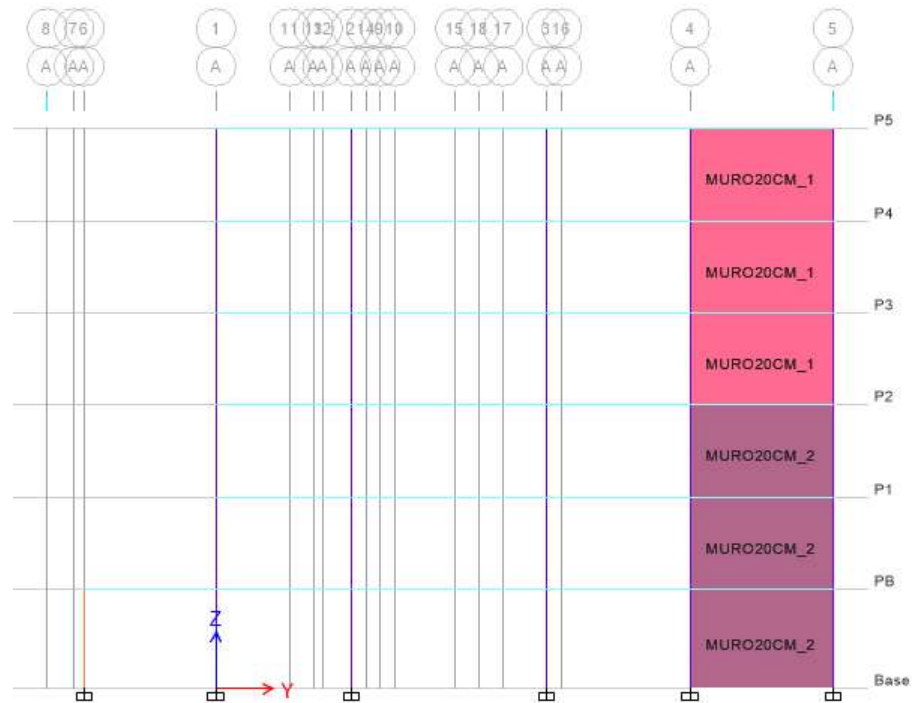
Figura 3.9: Dimensionamiento de muros.
