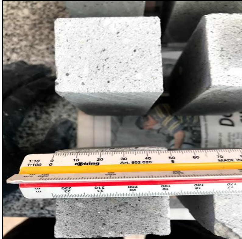
Figura 3.7 Medición de probetas del lado “a”
