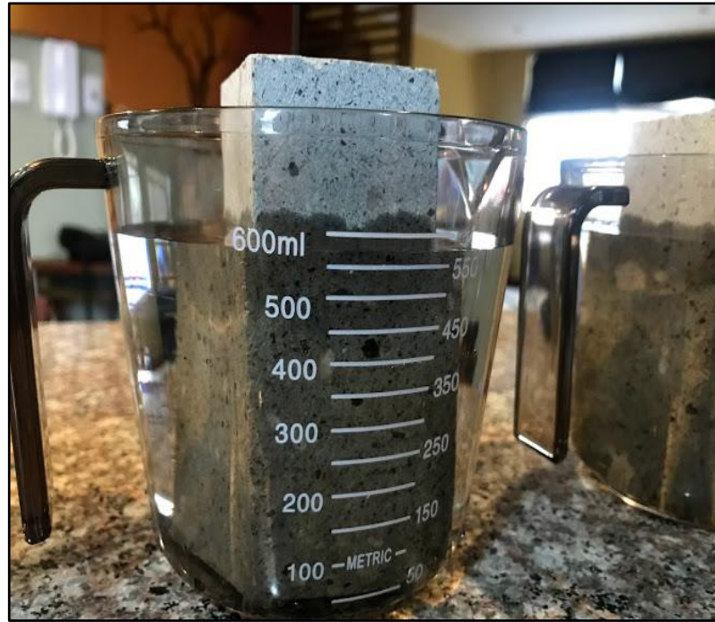
Figura 3.22 Probeta sumergida en el vaso de precipitación
