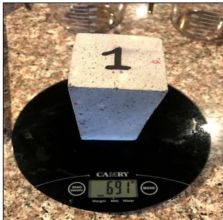
Figura 3.25 Peso probeta seca
