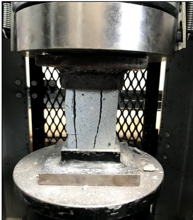
Figura 3.29 Ruptura de probeta en la prensa de Humboldt
