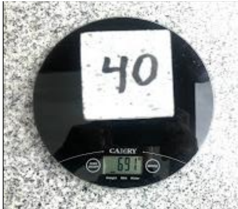
Figura 3.12 Pesado de la probeta de roca número "40"
