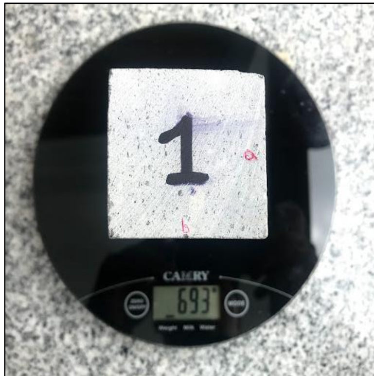
Figura 3.10 Pesado de la probeta de roca número "1"
