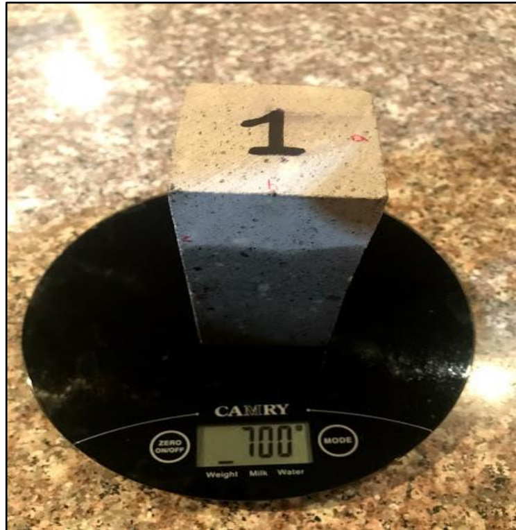
Figura 3.26 Peso probeta mojada
