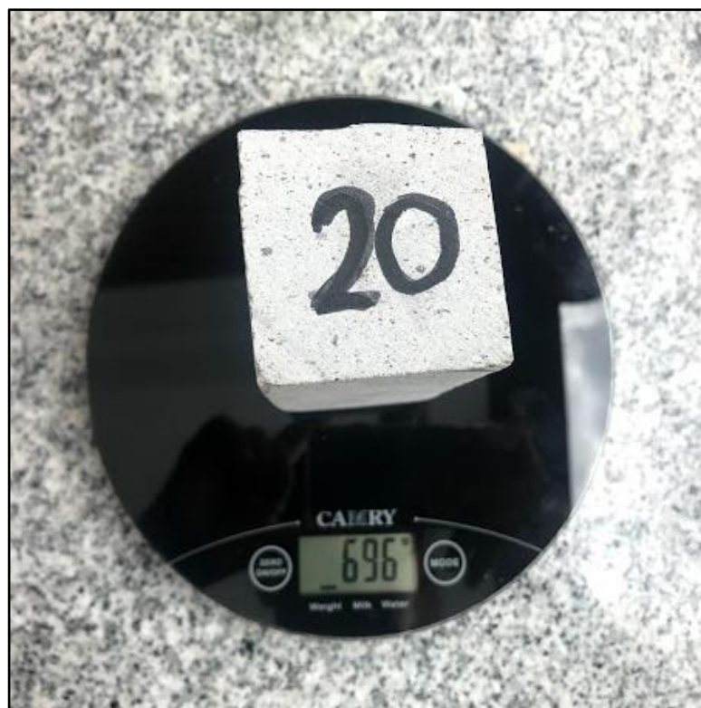
Figura 3.11 Pesado de la probeta de roca número "20"
