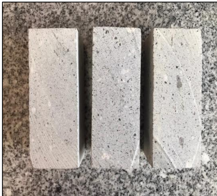
Figura 3.3 Geometría de las probetas cortadas según las medidas específicas
