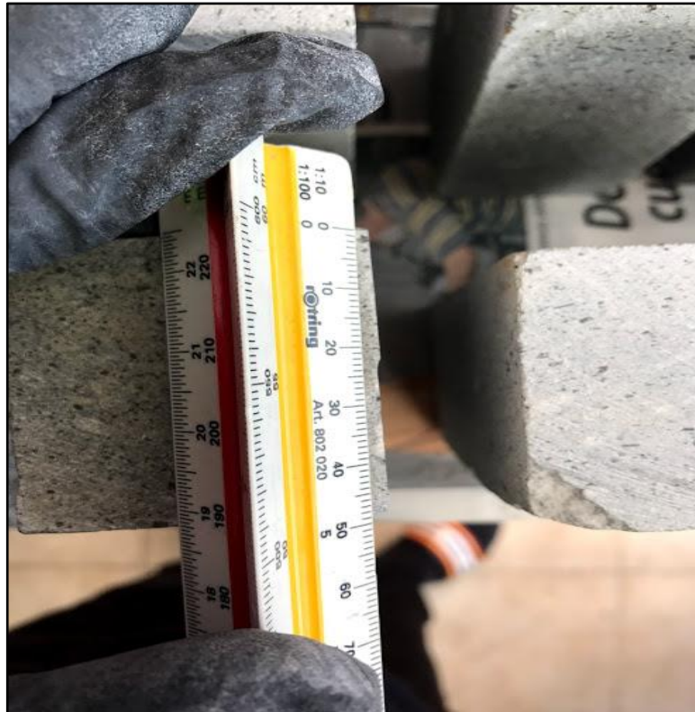
Figura 3.8 Medición de probetas del lado “b”
