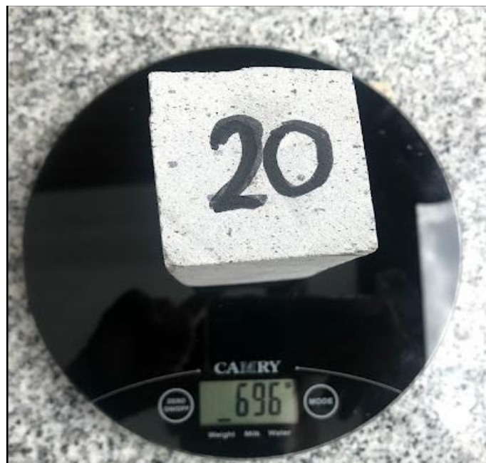
Figura 3.16 Peso inicial de la probeta "20"
