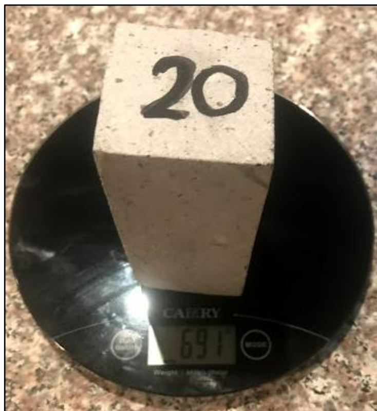
Figura 3.18 Peso final de la probeta "20"
