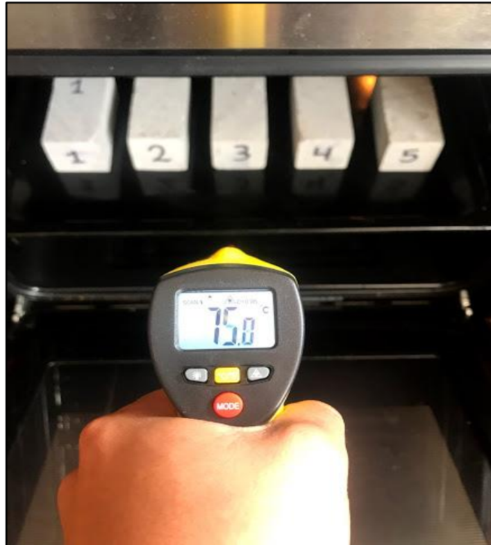
Figura 3.15 Temperatura promedio del horno
