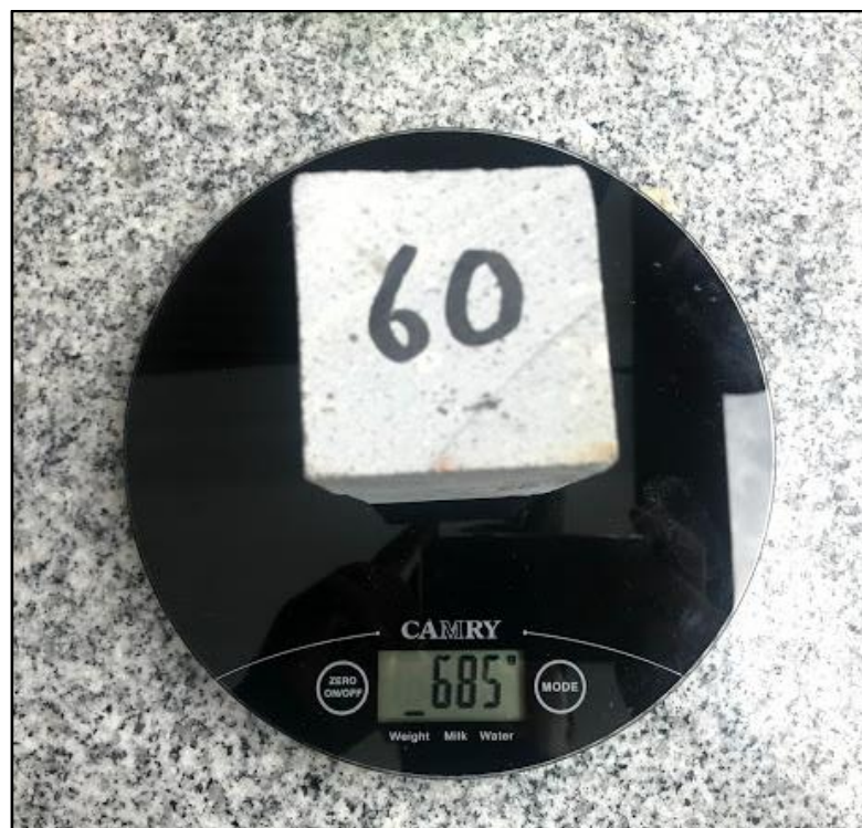
Figura 3.13 Pesado de la probeta de roca número "60"
