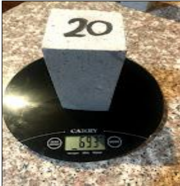
Figura 3.17 Peso medio de la probeta "20"
