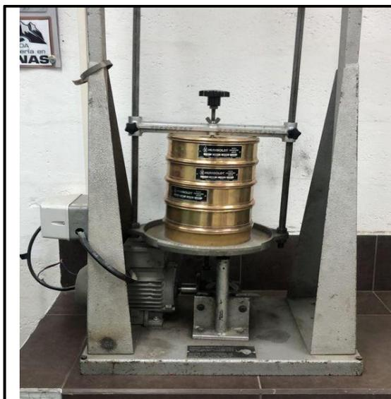
**Figura 2.2** Juego de tamices de Tyler para análisis granulométrico.
