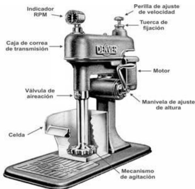
**Figura 1.5.** Celda Denver con sus respectivas partes
