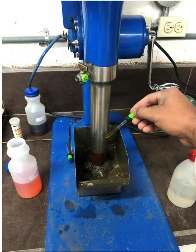
Anexo 25. Dosificación de colectores previo a la flotación en celda Denver
