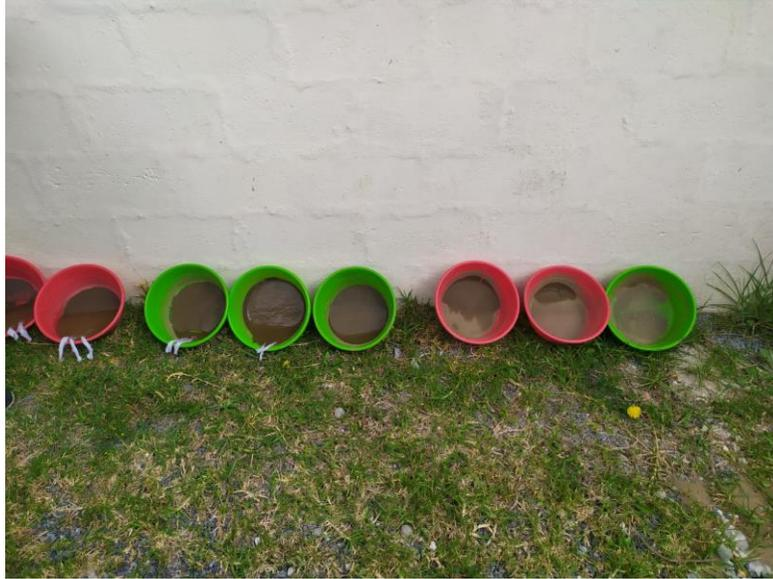
Anexo 27. Secado de muestras del proceso de flotación
