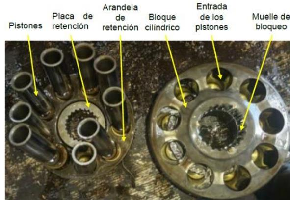
*Figura 46.* Desmontaje de una bomba de pistones
