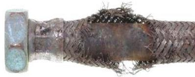
*Figura 43.* Manguera deteriorada
