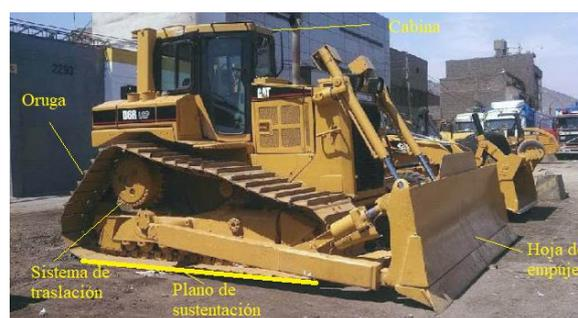
Figura 39. Principales partes de un tractor de oruga
