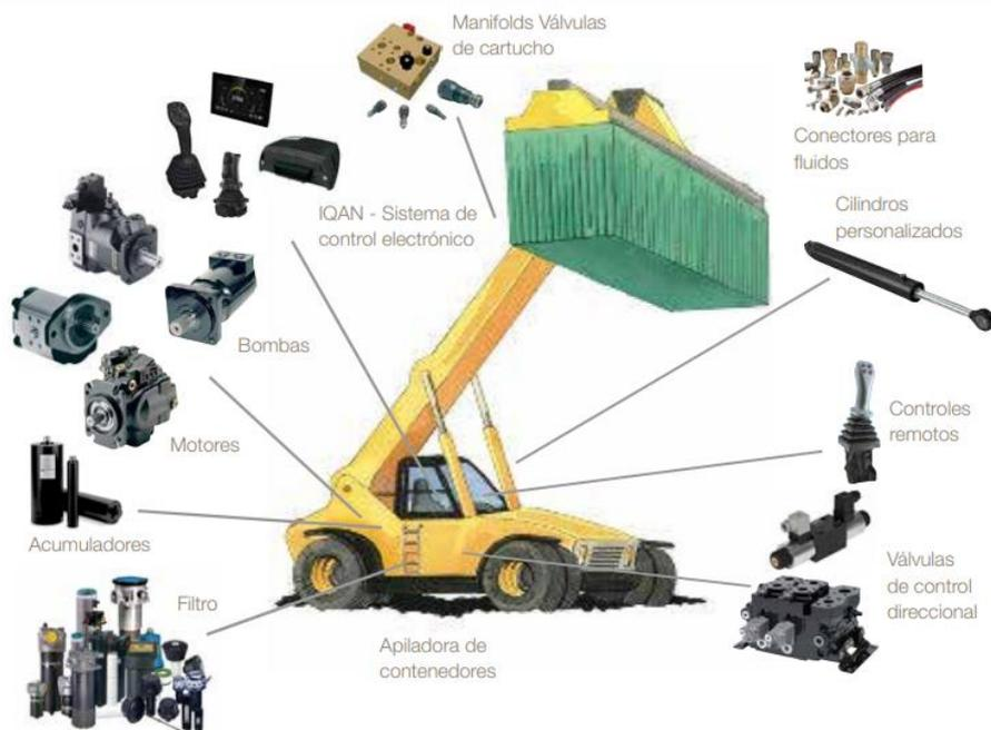
*Figura 2.* Aplicaciones de la oleo hidráulica en una apiladora de contenedores
