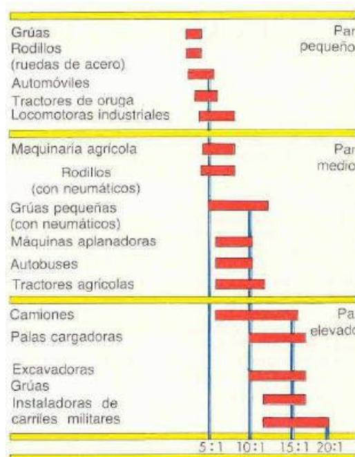
Figura 43. Requerimientos de par para varias maquinarias
