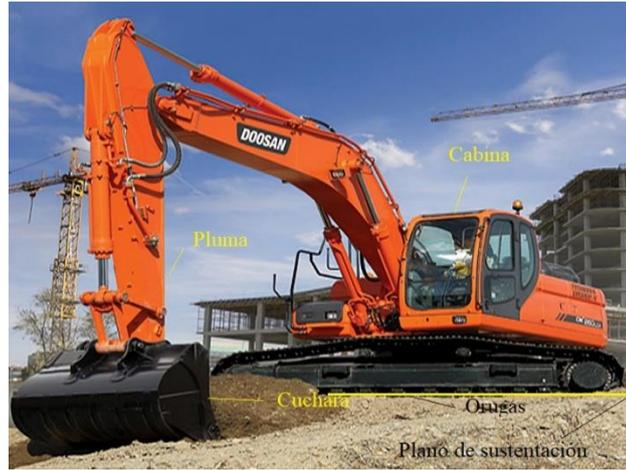
Figura 28. Principales partes de una excavadora de oruga
