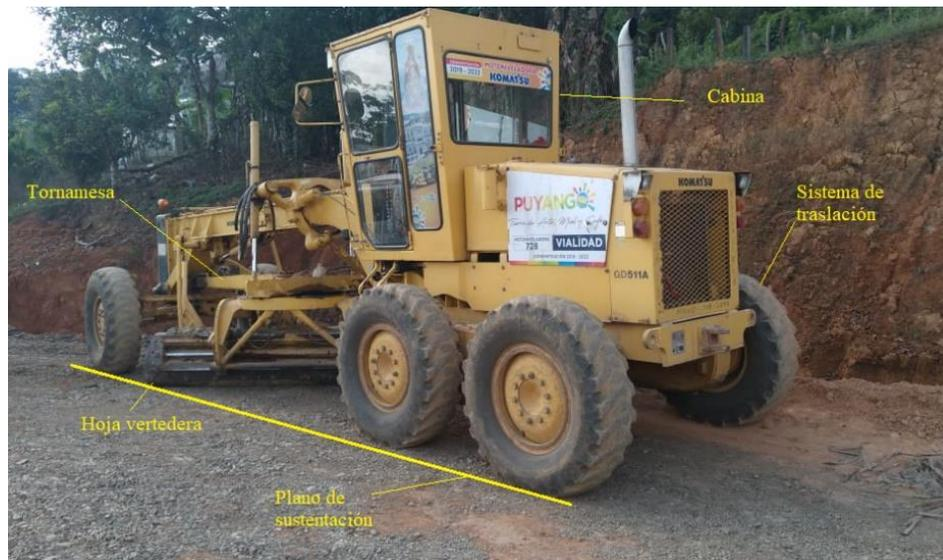
Figura 36. Principales partes de una motoniveladora
