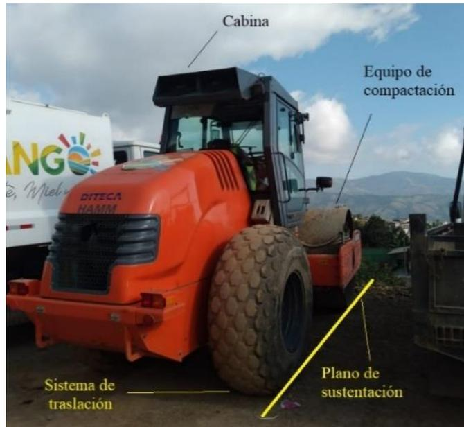
Figura 30. Principales partes de un rodillo
