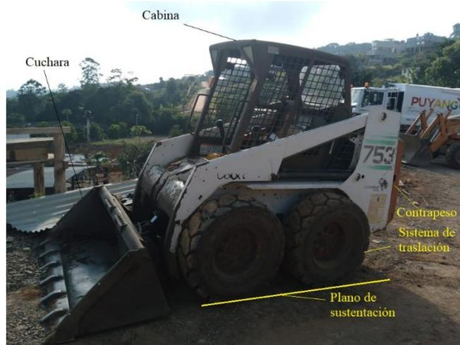
Figura 33. Principales partes de una minicargadora
