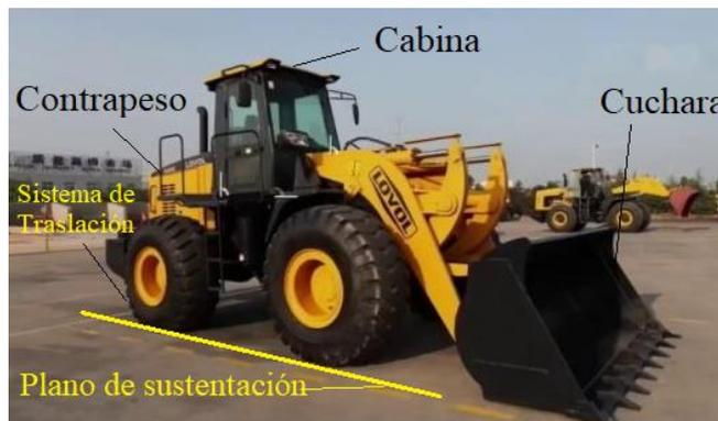
Figura 34. Principales partes de una cargadora sobre ruedas
