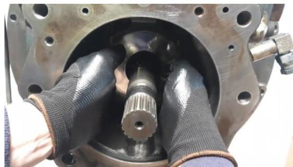
*Figura 42.* Estriado del eje de una bomba para excavadora
