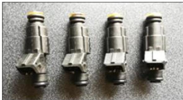
*Figura 12.* Inyectores del motor *Corsa Evolution 1.8L*.
