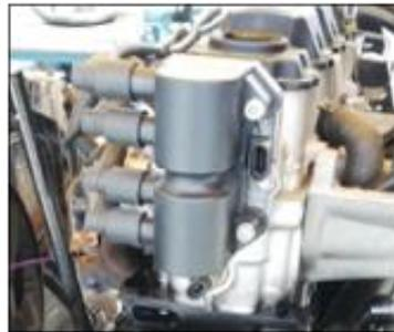
*Figura 15.* Bobina de encendido.
