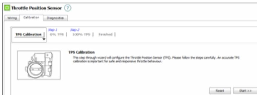
Figura 92. Calibración sensor TPS.
