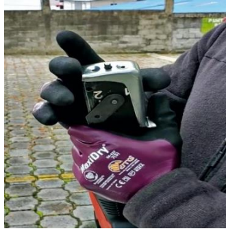
Figura 4.8. Colocación del conector en la herramienta DX 76
