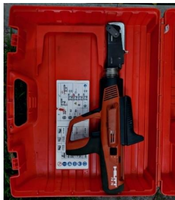
Figura 2.10. Herramienta de fijación directa DX 76.
