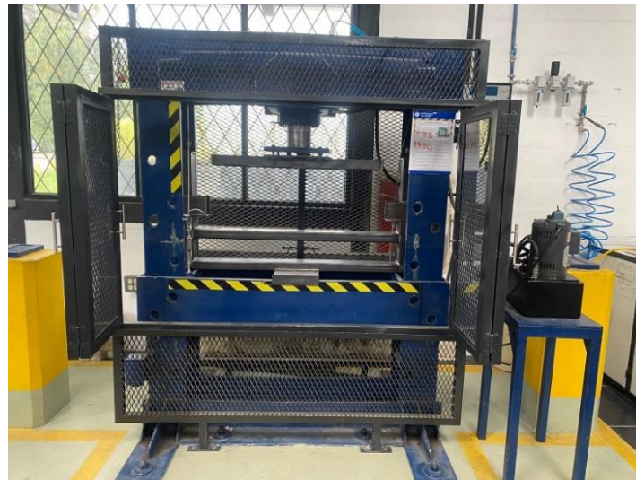
Figura 4.3. Base Metálica colocada en la Prensa
