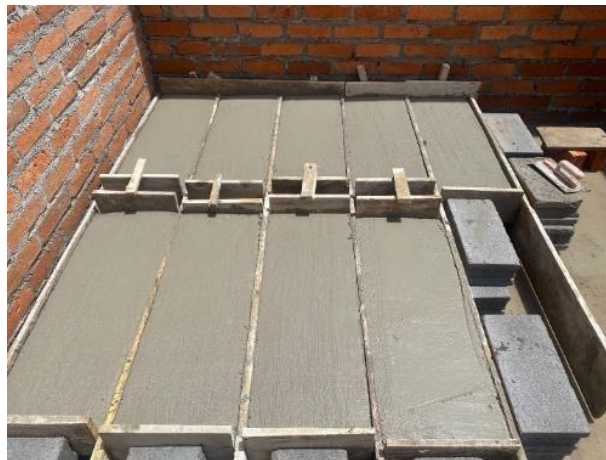
Figura 4.24. Finalización de la fundición de las probetas
