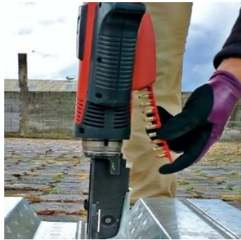
Figura 4.9. Situar el cartucho la parte lateral de la herramienta
