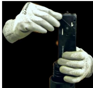
Figura 4.6. Posición 1 de la herramienta de fijación directa DX 76
