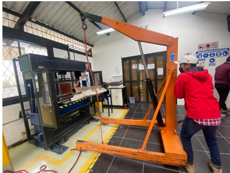
Figura 4.31. Montaje de las probetas en la prensa
