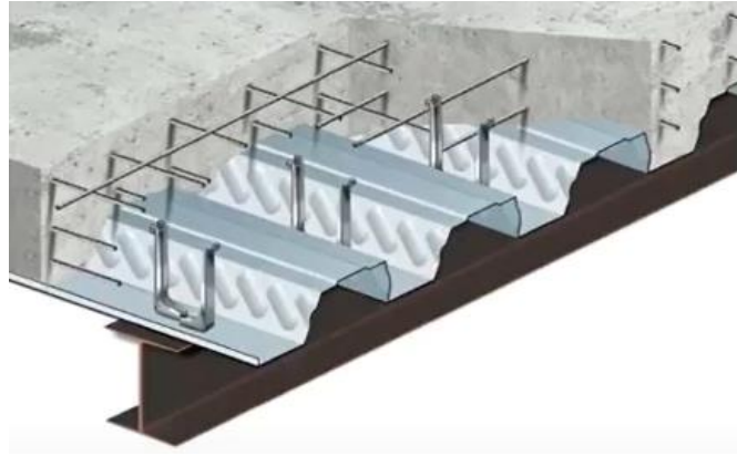
Figura 2.6. Conector X-HVB 95 en conjunto con la losa
