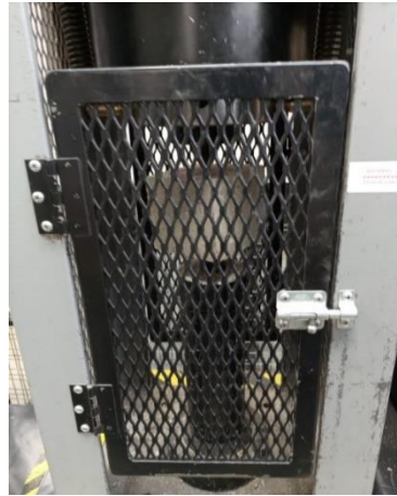
Figura 2.5 Muestra que será sometida a compresión simple.
