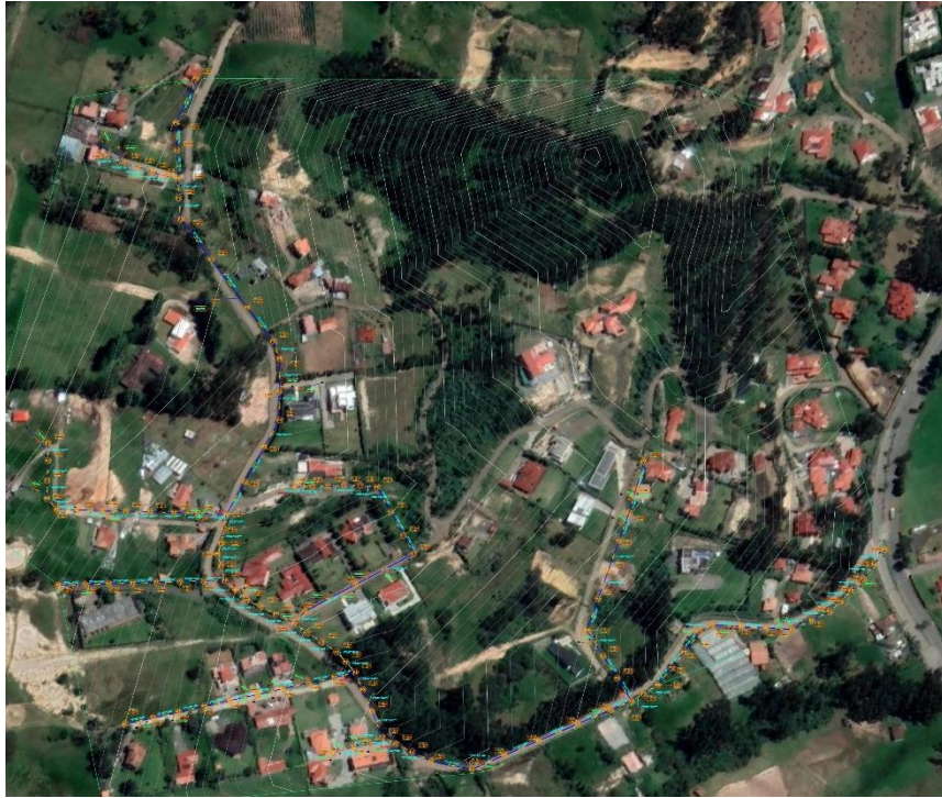
Figura 10 Diseño alcantarillado Fuente: Autores
