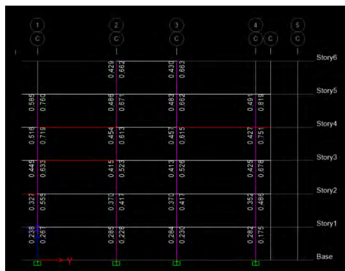
FIGURA 1.37 Comprobación columna fuerte viga débil
