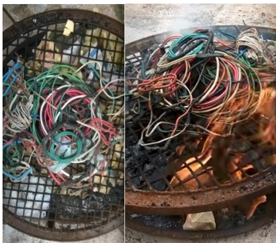
Figura 2. Quemado de cables
