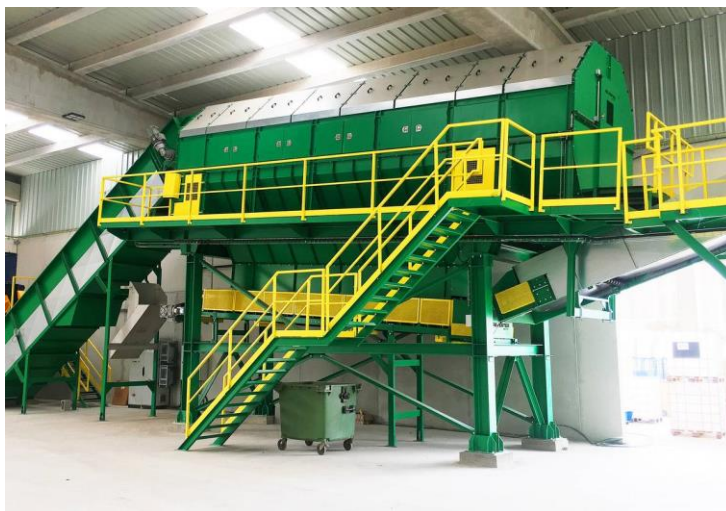
Figura 10 Tambor Cilíndrico para tamizado "Tromel"
