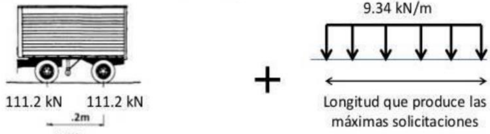
Figura 1.4. Tándem de Diseño y carga de carril de diseño Fuente: AASHTO LRFD (2020)
