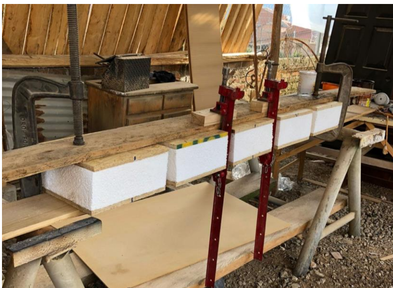
Figura 64. Colocación de prensas en probetas SIP.
