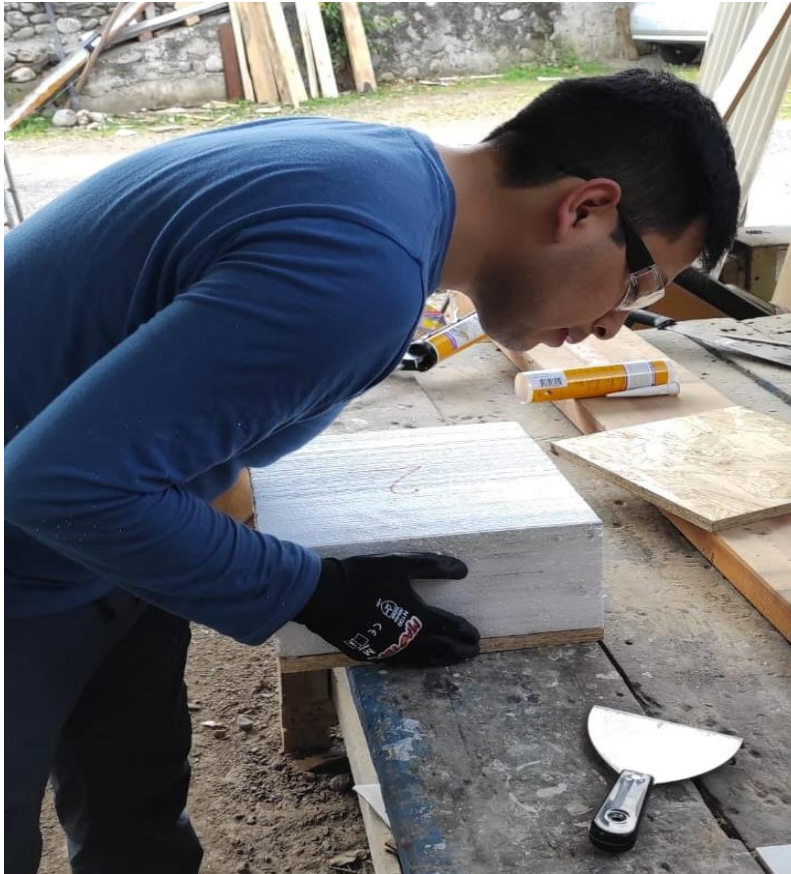
Figura 63. Armado de probetas SIP.
