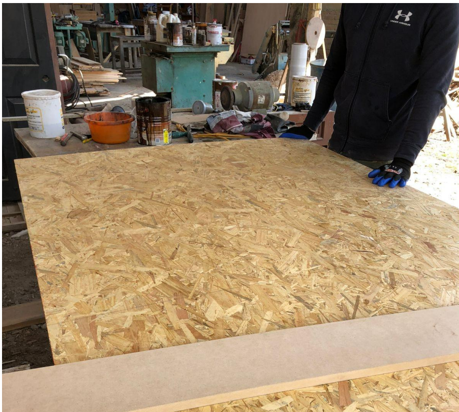
Figura 60. Plancha de fibras orientadas de madera OSB.
