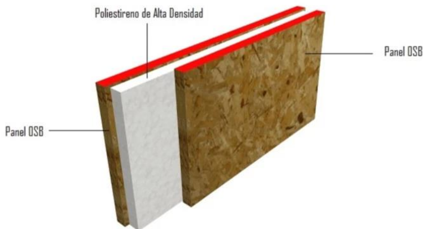
Figura 2 Componentes de un panel SIP de OSB.
