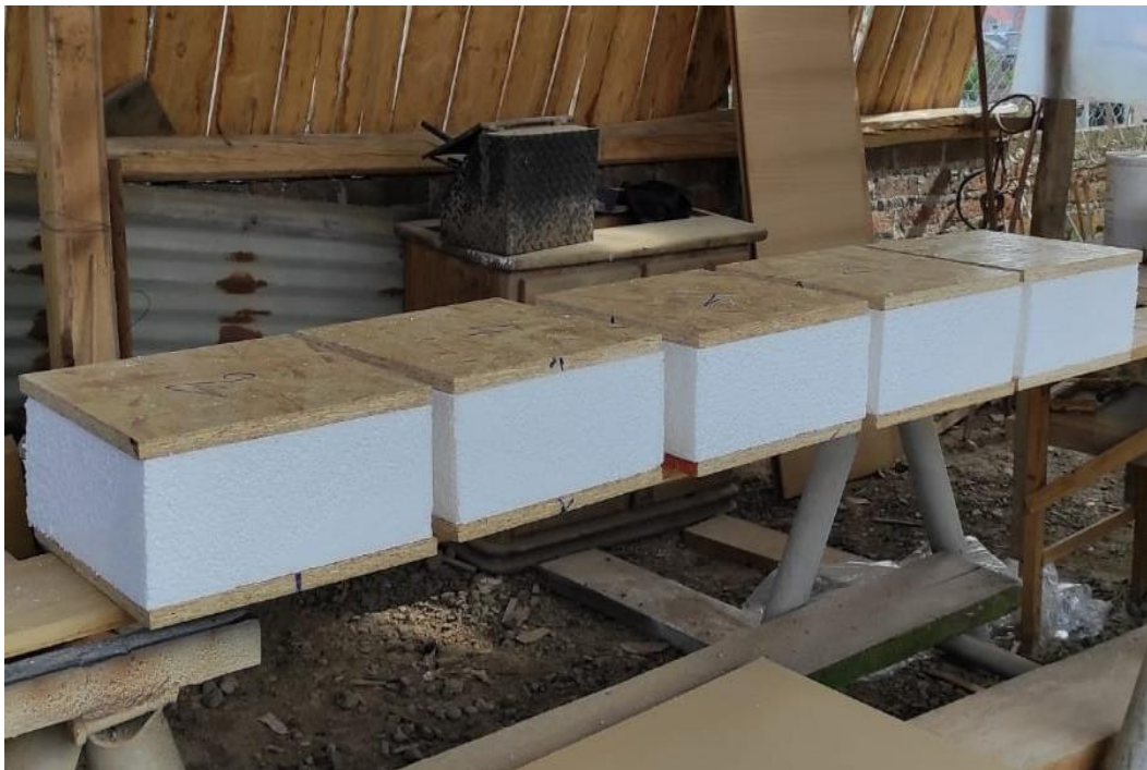
Figura 58. Probetas para ensayo de compresión axial.
