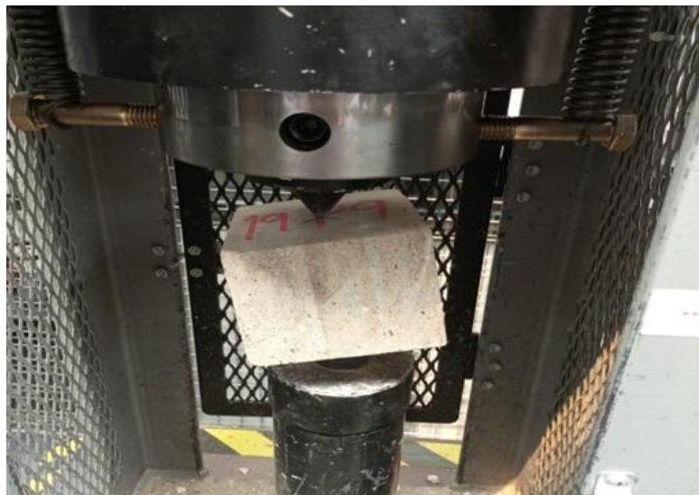
Figura 2.8: Probeta de andesita lista para el ensayo
