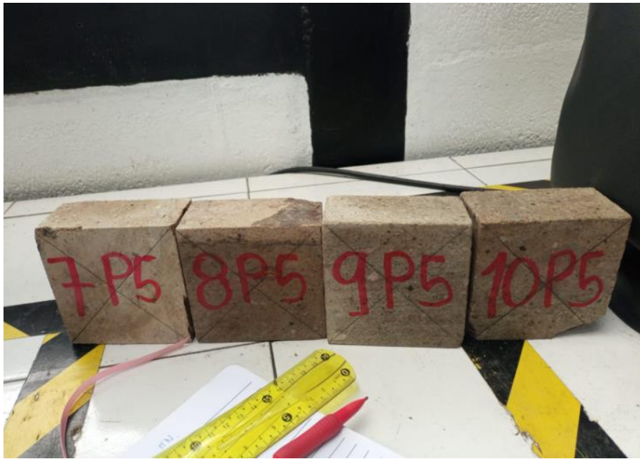
Figura 2.9: Cruz centrada en las probetas.
