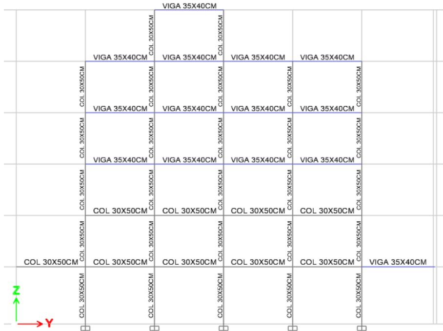
Ilustración 6. Vista en corte de los elementos: columnas, vigas.
