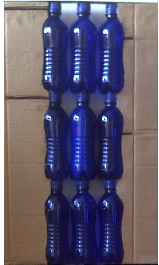
Botellas rellenas con papel periódico, con espuma de poliuretano de alto poder expansivo y sin relleno.
