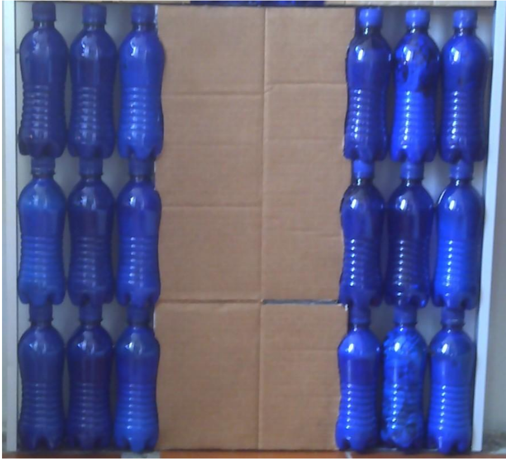
Botellas rellenas con papel periódico, con espuma de poliuretano de alto poder expansivo y sin relleno.
